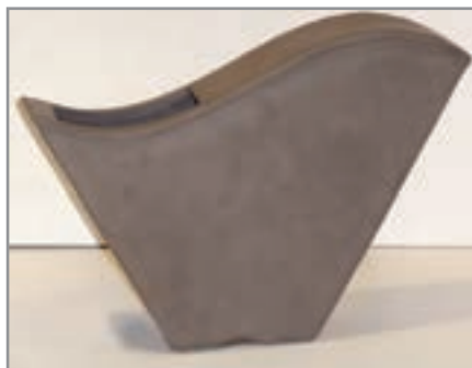
شکل ۱۰- انواع بدنه‌های شکل‌داده شده با روش ورقه‌ای
