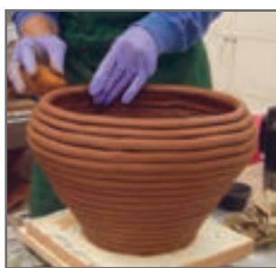
شکل ۹- بدنه‌های مختلف شکل‌دهی شده با روش فتیله‌ای
