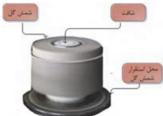
شکل ۱۵- استقرار شافت و شمش گل
