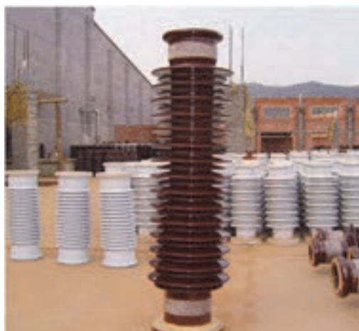
شکل ۲۶- نمونه‌هایی از مقره‌های پوشینگ و تابلویی
