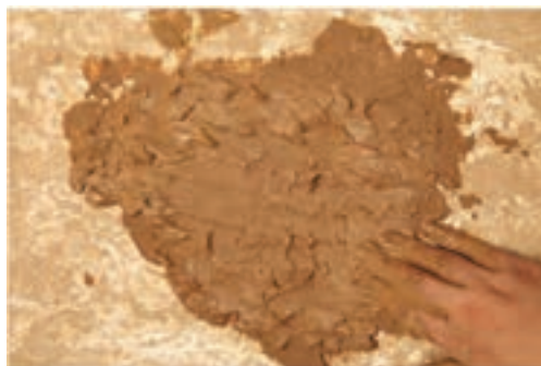
شکل ۱۰- تهیهٔ گل یکنواخت با دوغاب
