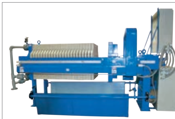
شکل ۲۸- دستگاه فیلتر پرس و اجزای آن
