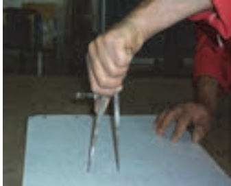
شکل ۱۵- استفاده از پرگار برای رسم دایره بر ورق فلزی
