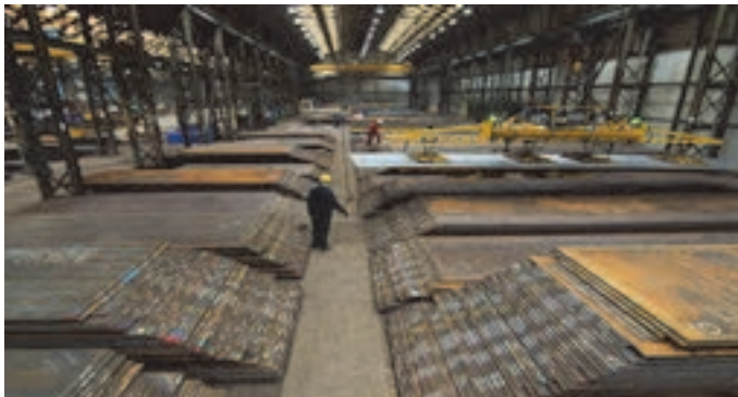
شکل ۱- محل نگهداری ورق‌های فولادی در محوطه کشتی‌سازی "STOCK YARD"
