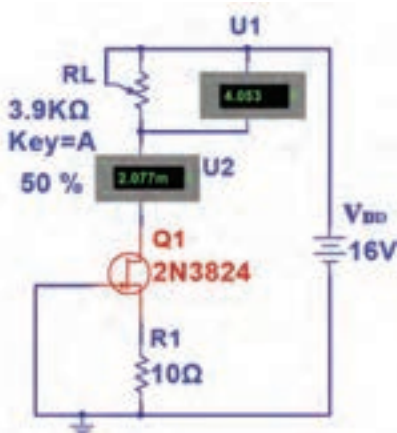
شکل ۳۳-۴- مدار منبع جریان با FET
