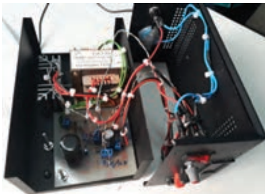
شکل ۱۳-۲- پنل منبع تغذیه ساخته شده با LM338 شکل ۱۴-۲- مدار داخلی و قطعات منبع تغذیه ساخته شده با LM338
