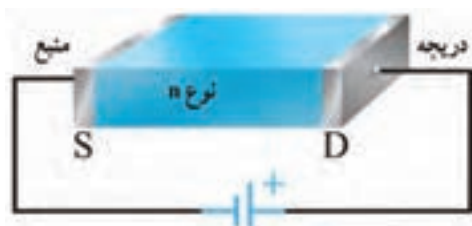
شکل ۴-۱۷- نیمه‌هادی با ناخالصی N به عنوان کانال
