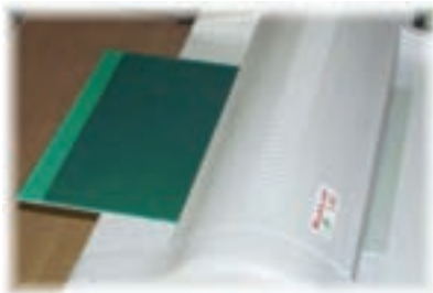
شکل ۳-۱۶- خروج فیبر از لمینتور
