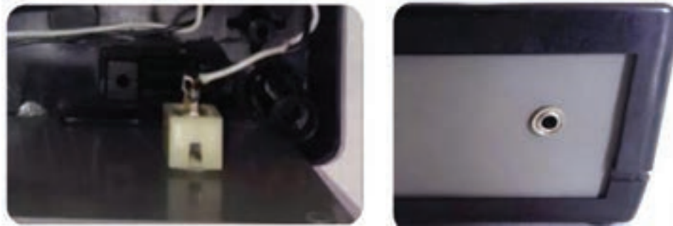
شکل ۱۷-۵- استفاده از ترمینال بلندگو در پروژه (پشت جعبه)
