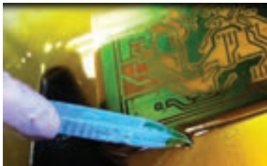
شکل ۳-۲۶- فیبر ظاهر شده پس از شست‌وشو شکل ۳-۲۷- قرار دادن فیبر داخل اسید شکل ۳-۲۸- خروج فیبر از اسید
