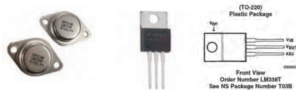
شکل ۲-۳- آی‌سی رگولاتور TO220 با بسته‌بندی سرامیکی شکل ۲-۴- آی‌سی رگولاتور TO3 با بسته‌بندی فلزی
