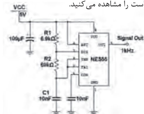
شکل ۲-۲۷- مدار مولد موج مربعی با آی سی ۵۵۵
