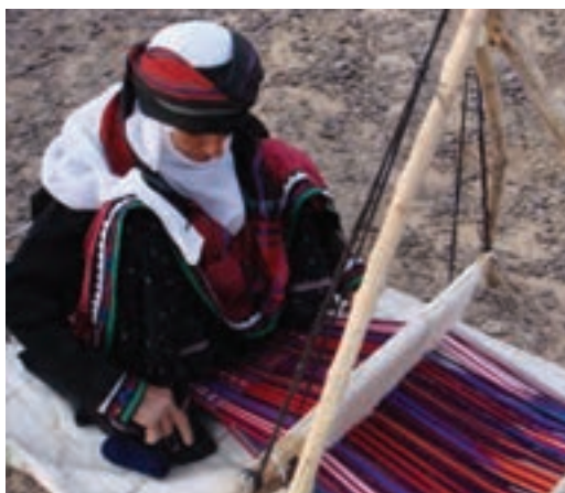
شکل ۱۹-۳- چله‌ریزی بر روی دستگاه برای بافت جاجیم
