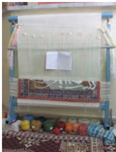
شکل ۱۰-۱- زیر دار ثابت و سردار متحرک (مدل ۲)
