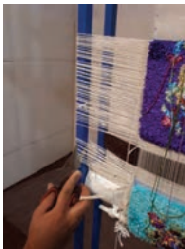
شکل ۳۴- ۵- بریدن انتهای پودها قبل از پایین کشی
