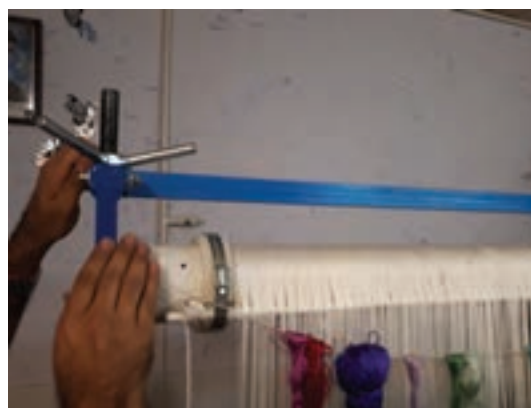
شکل ۳۵- ۵- شل کردن دار
