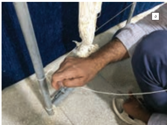
شکل ۷-۳- بازکردن نخ‌های کمکی
