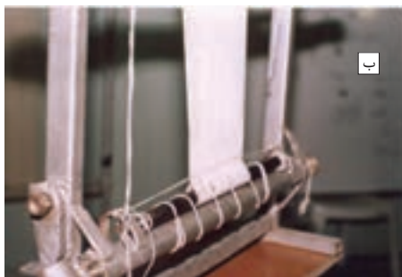
شکل ۱۱-۳- دوخت به روش میله کمکی
