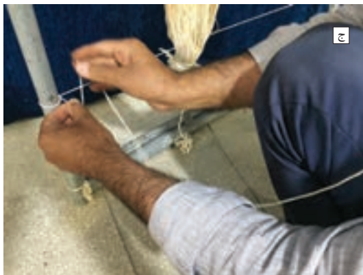
شکل ۷-۳- بازکردن نخ‌های کمکی
