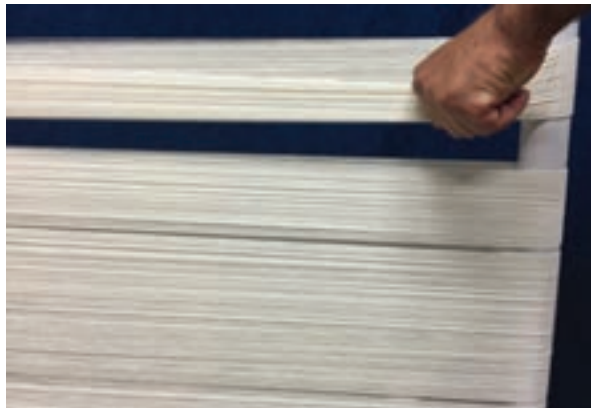
شکل ۳۰-۲- تنظیم تارها بر روی میله
