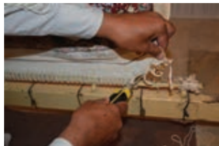
شکل ۱۳-۵ - بریدن دوخت ابتدای چله
