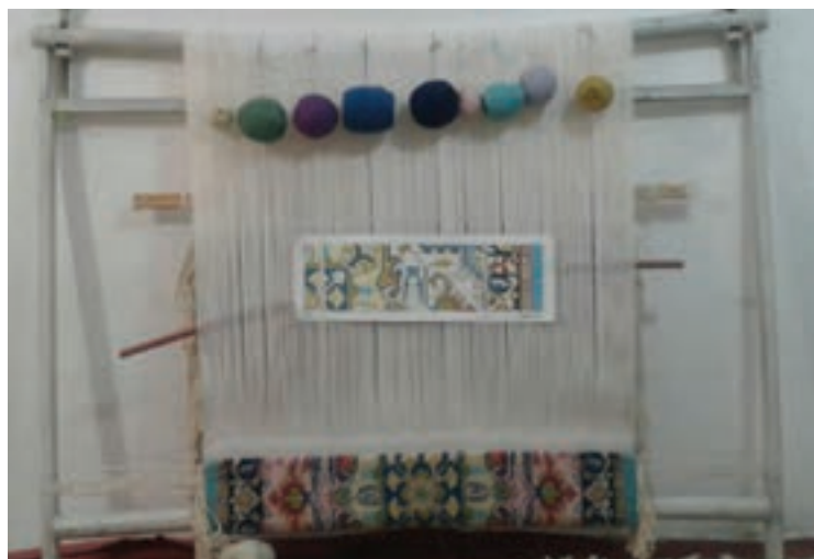
شکل ۲۰-۱- مقاوم نبودن سر دار و زیر دار در این تصویر کاملاً مشهود است.
