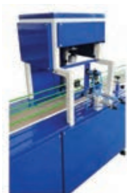
شکل ۲۲- دستگاه دربند
