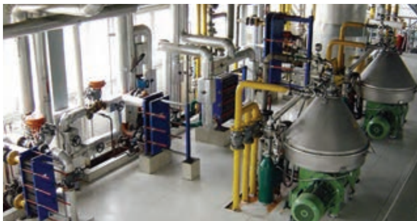
شکل ۶- سیستم خنثی‌سازی مداوم روغن
