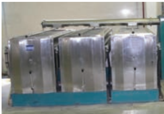
شکل ۱۵- دستگاه مالاکسور
