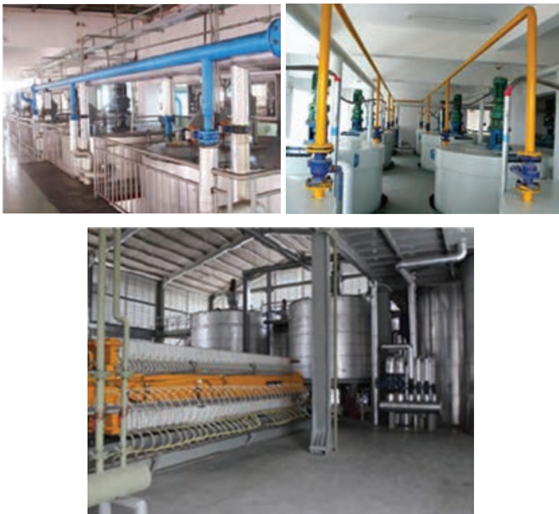
شکل ۱۰- سیستم تجهیزاتی جزء به جزء کردن روغن
