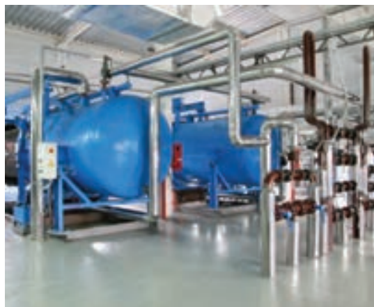
شکل ۱۲- سیستم زمستانه کردن روغن ها
