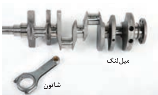
شکل ۱۰- میل لنگ و شاتون
