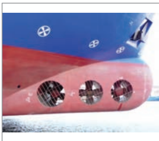
شکل ۵ - سامانه bow thruster
