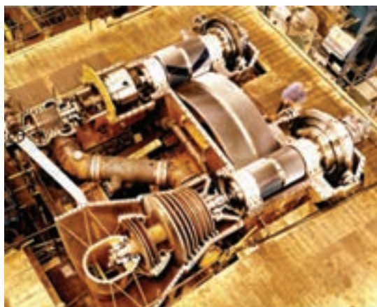
شکل ۲۱- توربین بخار به همراه جعبه دنده
