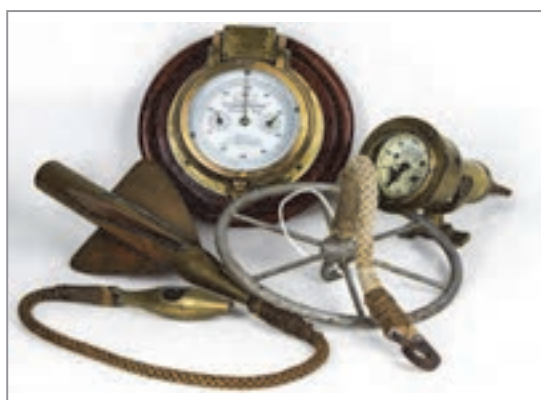
شکل ۲۲- سرعت سنج چرخنده یا ثبت کننده
