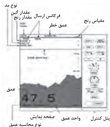
شکل ۱۸- مشخصه ها و نشاندهای نمایشگر عمق یاب
