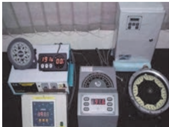
شکل ۳- قطب‌نمای الکتریکی (جایرو) و متعلقات آن
