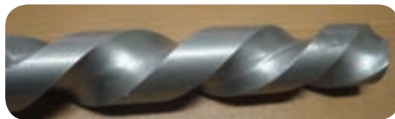
ایجاد شیار مارپیچ در یک میله گرد
