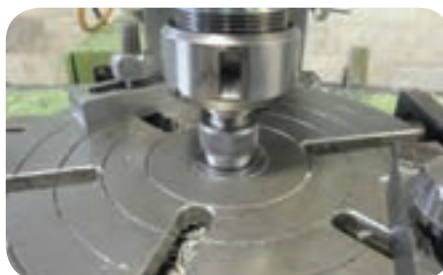
هم محور کردن گلویی دستگاه با مرکز میزگردان به کمک یک میله تنظیم
