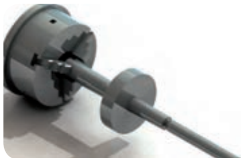
سوار کردن درن بر روی دستگاه تقسیم
