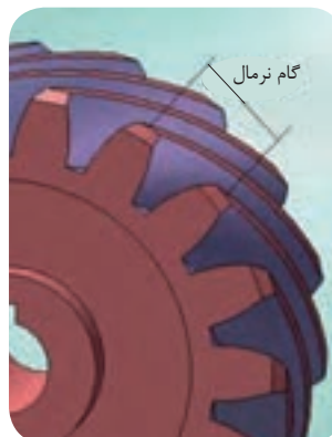
نمایشی گام نرمال در چرخ‌دنده مارپیچ
