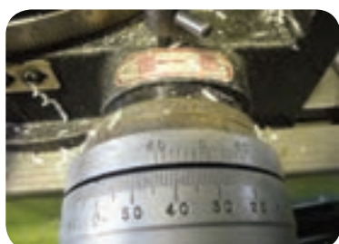
حلقه مدرج دستگیره میزگردان برای جابجایی دقیق‌تر
