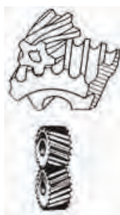
درگیری دو چرخ‌دنده مارپیچی
