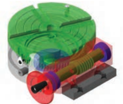
نمایش سیستم داخلی میزگردان
