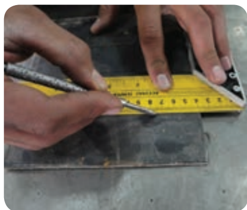
روش ترسیم خط به کمک گونپای ساده و سوزن خطکش
