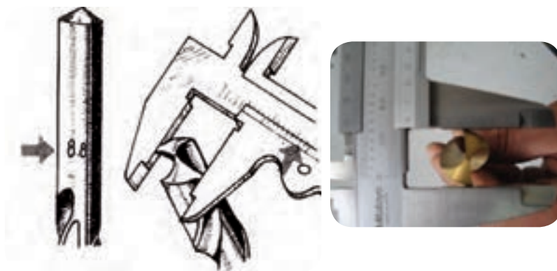
نحوه اندازه‌گیری صحیح قطر مته با کولیس
