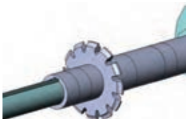
نحوه قرار دادن تیغۀ فرز مدولی روی میله فرز گیر
