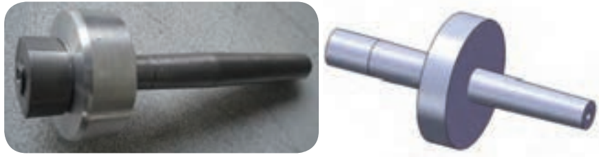
سوار کردن قطعه بر روی محور مخروطی
