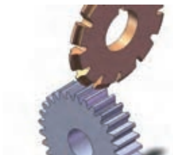
نمایش تیغه فرز مدولی و قطعه کار
