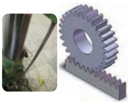
کاربرد چرخ و شانه در ماشین‌های مته
