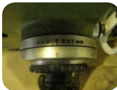
صفر کردن ورنیه دستگاه
