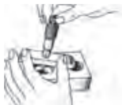
کنترل عمق سوراخ با استفاده از میکرومتر
