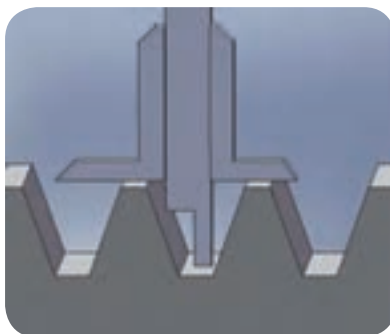
نحوه استفاده از کولیس عمق سنج
