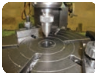
خروج میله و محکم کردن بست‌های میزگردان
