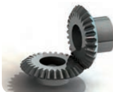
درگیری دو چرخ دنده مخروطی با یکدیگر
