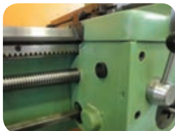
کاربرد چرخ و شانه در ماشین‌های تراش
