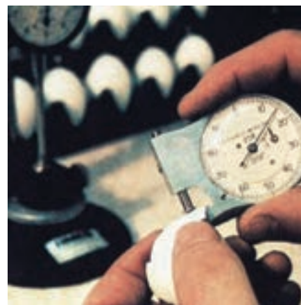
تصویر ۱-۲۵ - اندازه‌گیری ضخامت پوسته با میکرومتر
