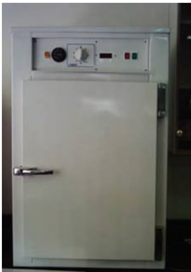
شکل ۱-۳- دستگاه خشک کن (اُون)
