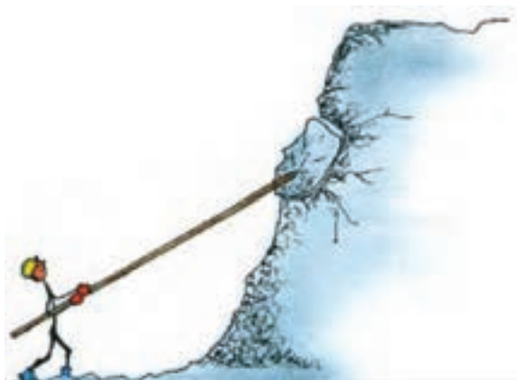
لق‌گیری با چوب بلند و از پایین
