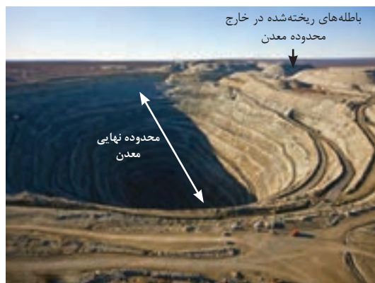
یک معدن در حال استخراج به روش پله ای و شکل شماتیک مقطع عرضی آن
