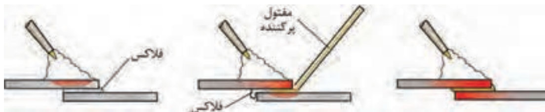
شکل ۲۴- مراحل مختلف جوش با مفتول برنجی
