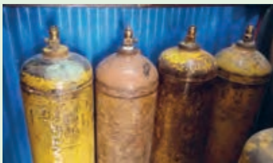
شکل ۱۶- کپسول های حاوی گاز استیلن
