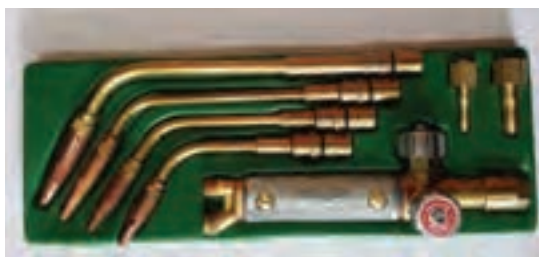
شکل ۲۰- مشعل و سر بک‌های قابل تعویض جوشکاری
