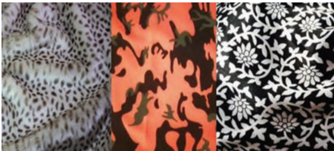
شکل ۳۰- نمونه‌های چند پارچه آکرلیکی چاپ‌شده با مواد رنگزای بازیک
