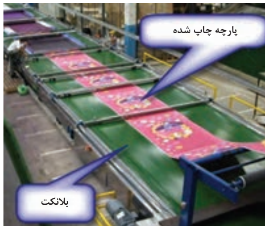
شکل ۹- بلانکت و محل قرار گیری بلانکت و پارچه چاپ شده
