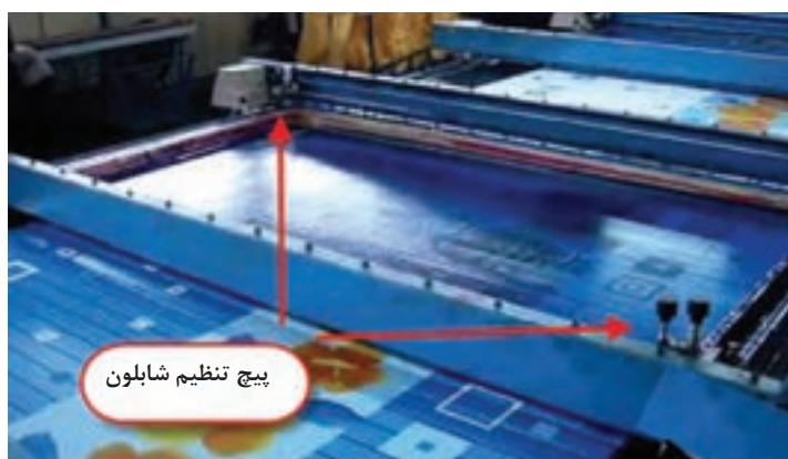
شکل ۱۰- پیچ‌های تنظیم شابلون
