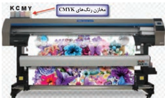
شکل ۲۵- نمونه ماشین چاپ دیجیتال ۴ رنگ
