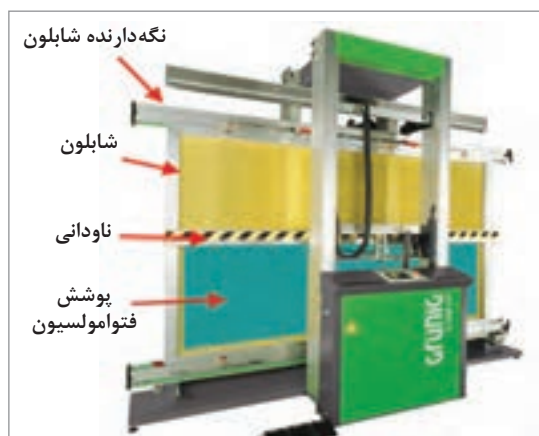
شکل ۱۳- ماشین لاک‌کشی شابلون تخت
