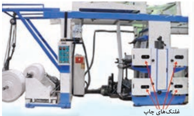
شکل ۱۴- نمای یک ماشین چاپ غلتکی
