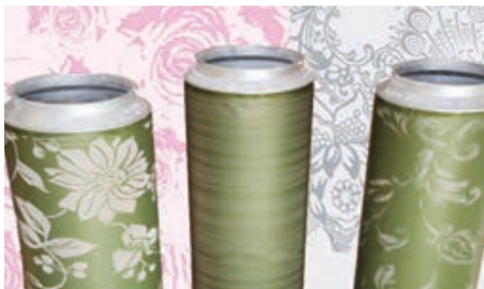
شکل ۲۱- اندرینگ و نحوه قرارگیری آن روی شابلون روتاری و محل قرارگیری راکل و شفت
