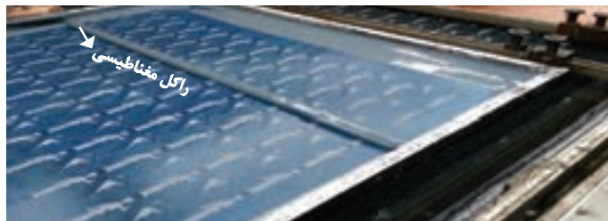
شکل ۱۲- راکل میله‌ای آهن ربایی (مغناطیسی)
