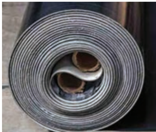
شکل ۹- بلانکت و محل قرار گیری بلانکت و پارچه چاپ شده
