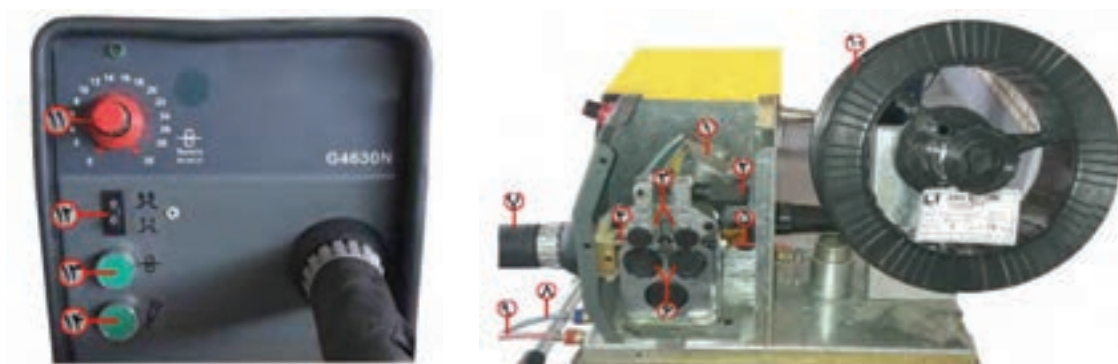
شکل ۱۵- اجزای منبع تغذیه سیم جوش
