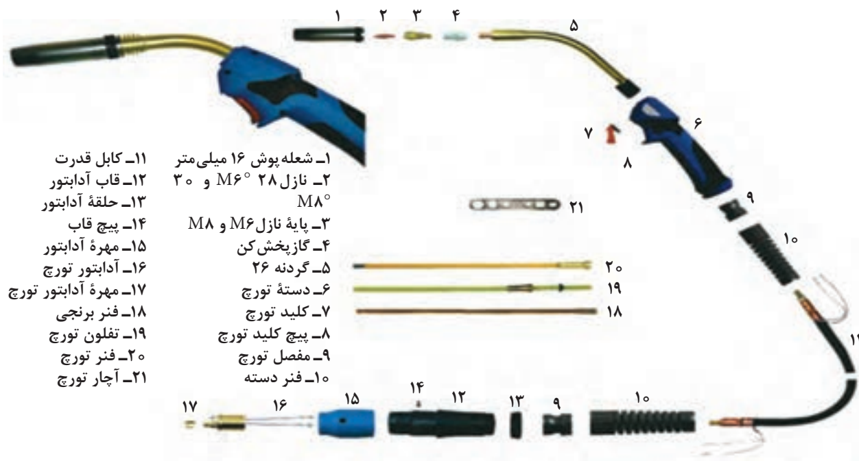
شکل ۷- اجزای تشکیل دهنده تورچ GMAW
