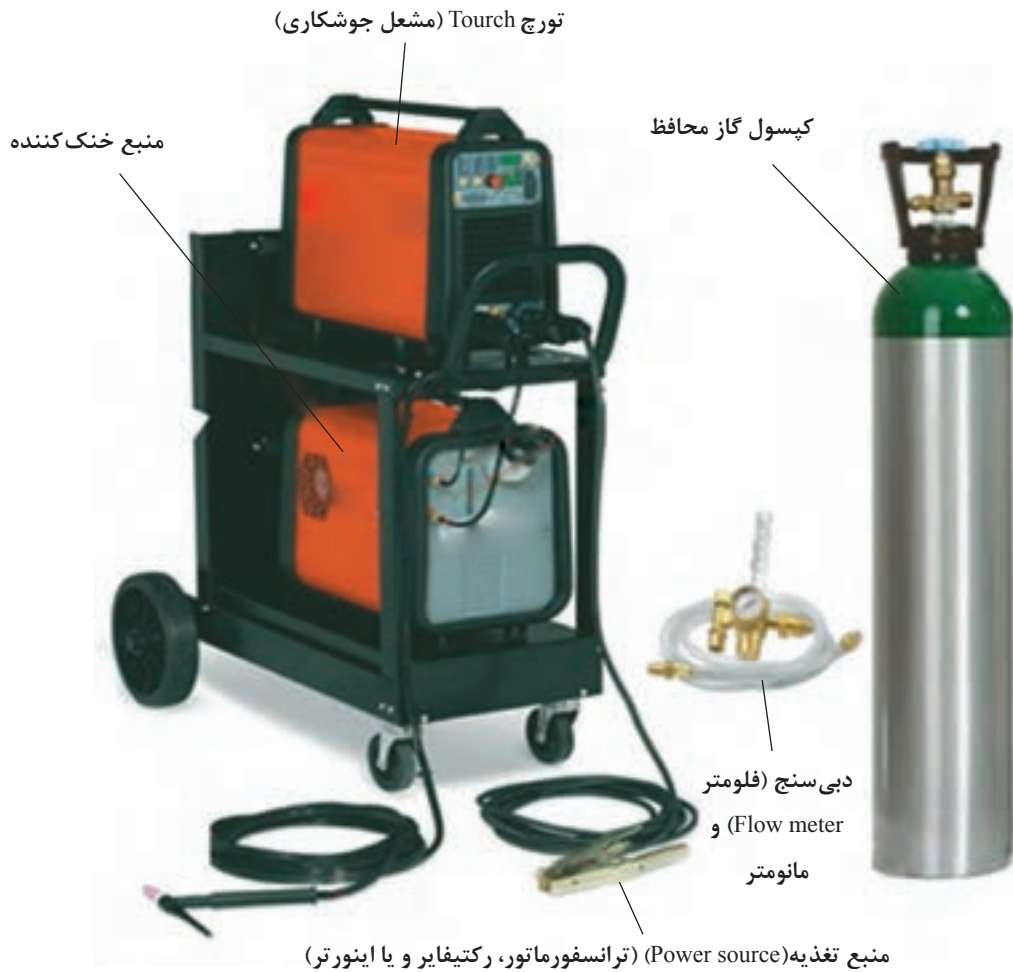
شکل ۲- تجهیزات فرآیند GTAW
