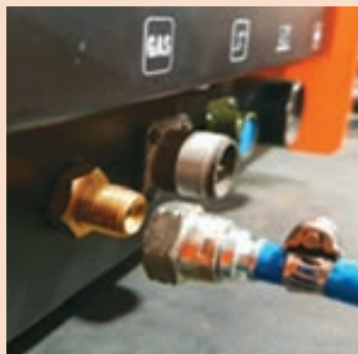
شکل ۶- نصب اتصال گاز محافظ
