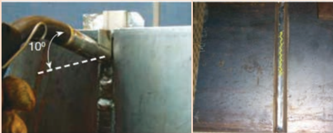
شکل ۲۴- زاویه تورچ و جهت حرکت آن
