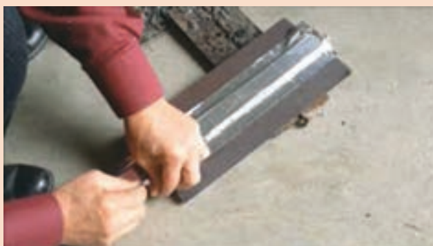
شکل ۱۸- نصب پشت بند سرامیکی
