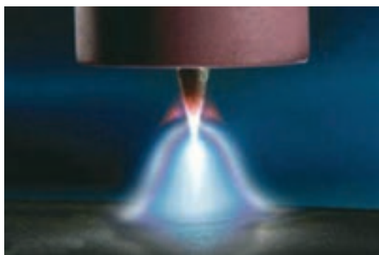
شکل ۱۳- ستون گاز آرگون یونیزه شده با قدرت تمرکز بالا
