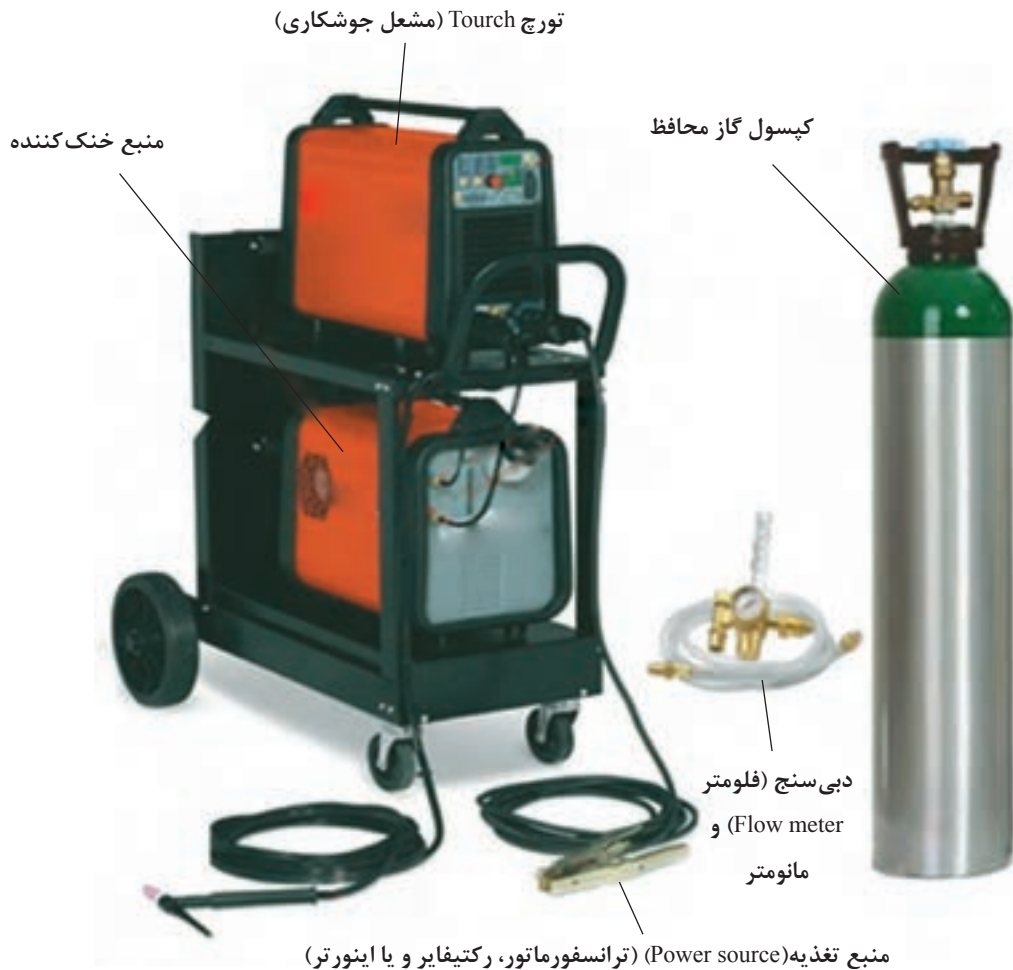
شکل ۲- تجهیزات فرآیند GTAW
