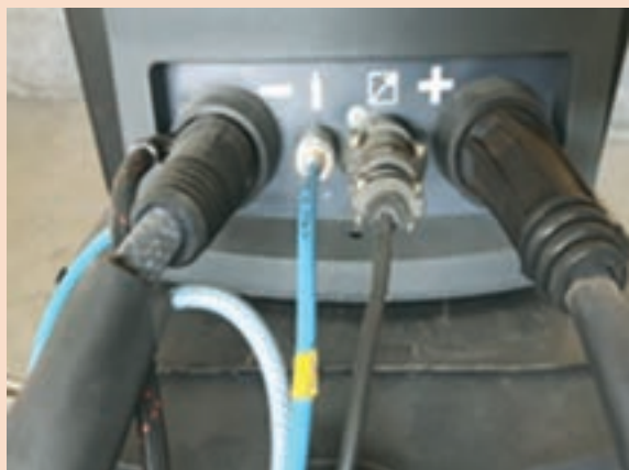
شکل ۹- کابل اتصال سوئیچی
