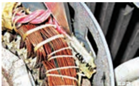
شکل ۳۶- محافظ حرارتی سیم پیچ موتور
