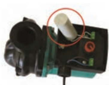
شکل ۳۵- خازن در جعبه برق موتور
