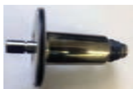
شکل ۱۱- روتور داخل محفظه فولادی
