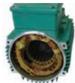
شکل ۱۰- ساختار استاتور
