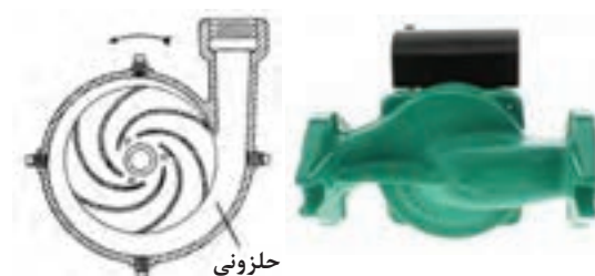
شکل ۷- پوسته حلزونی در پمپ خطی و زمینی
