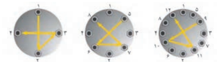
شکل ۲۳- ترتیب سفت کردن پیچ‌های فلنج
