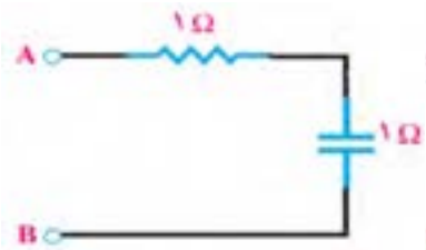
شکل ۹-۶۸- مدار RC سری
