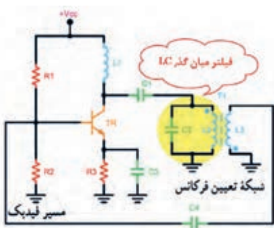
شکل ۴۴-۱۰ نوسان ساز آرمسترانگ
