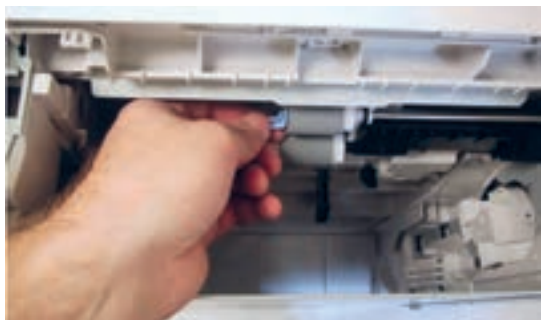
شکل ۳-۲۲- تعویض Separation Roller
