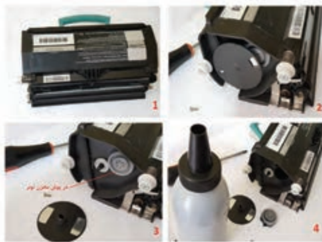
شکل ۴۸-۳- مراحل شارژ یک نمونه کارتریج لیزری
