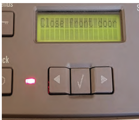
شکل ۴۹-۳- پیام خطای باز بودن یکی از درهای دستگاه
