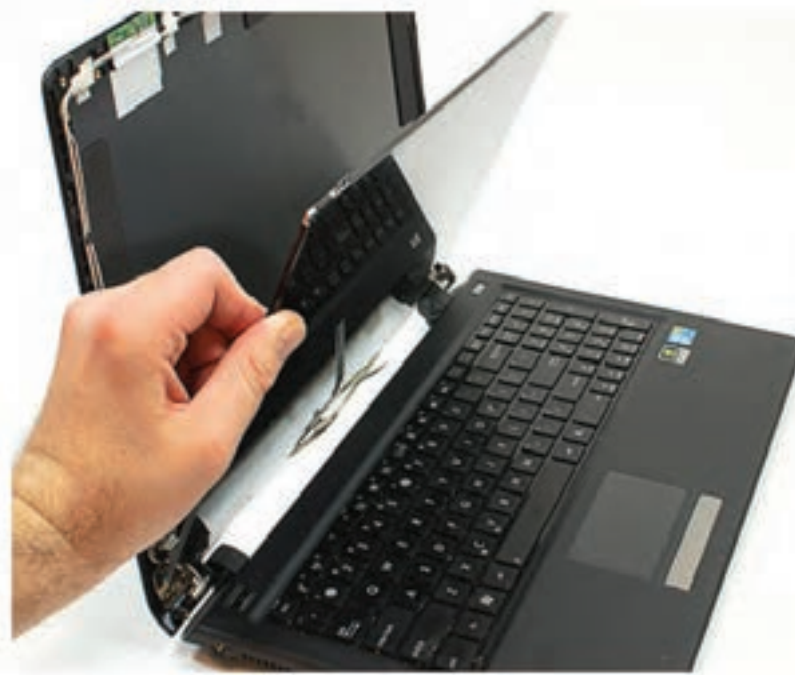
شکل ۵-۲۲- باز کردن نمایشگر لپ‌تاپ
