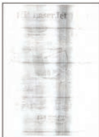
شکل ۴۴-۳- نمونه چاپ با کارتریج معیوب
