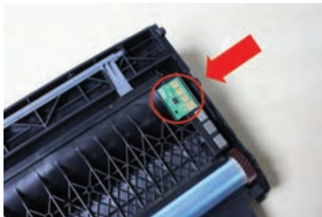
شکل ۴۶-۳- کارتریج مجهز به برد چیپ ست
