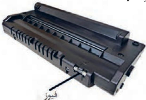
شکل ۳۱-۲ - کارت‌تریچ با فیوز
