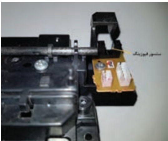
شکل ۳۵-۳- سنسور خروجی فیوزینگ یونیت
