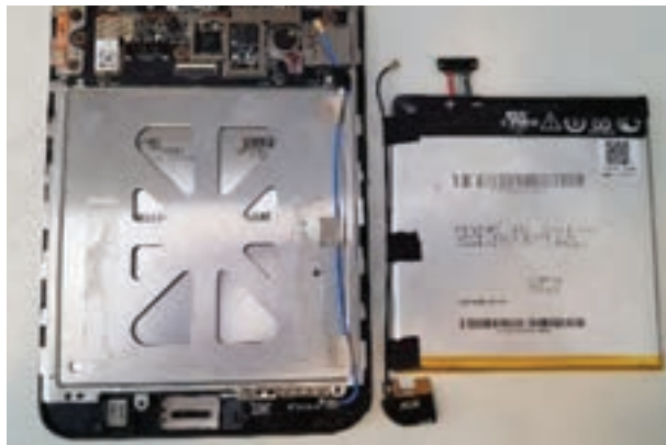
شکل ۳۰-۵- جدا کردن باتری از بدنه اصلی
