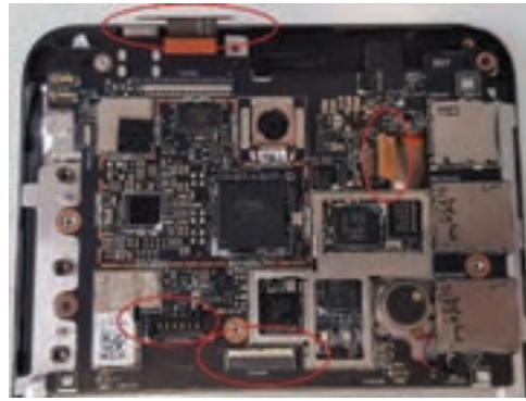
شکل ۵-۳۲- جدا کردن اتصال فلت‌ها به برد
