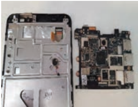
شکل ۵-۳۳- جدا کردن کامل برد از بدنه
