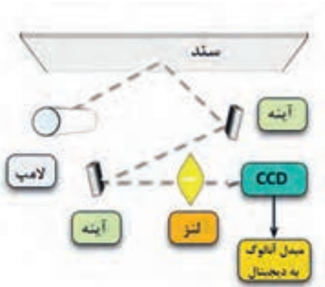
شکل ۱-۶۹- اجزاء تشکیل دهنده CCD
