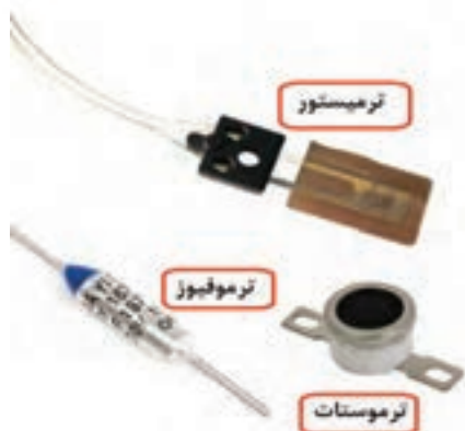
شکل ۲-۳۸ - قطعات حرارتی واحد فیوزینگ
