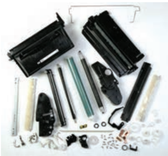
شکل ۲۸-۲ - قطعات تشکیل‌دهنده کارتریج All In One
