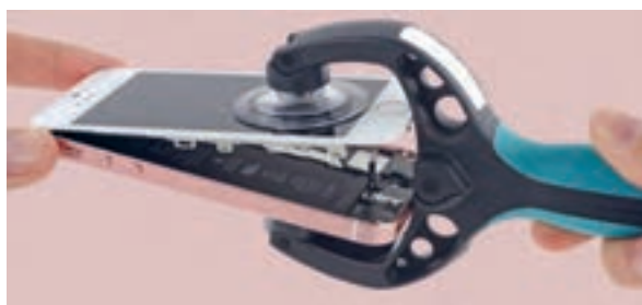
شکل ۵-۳۵- جدا کردن صفحه لمسی با ابزار وکیوم
