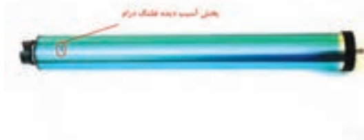
شکل ۴۵-۳- غلتک درام معیوب و اثر عیب درام بر روی چاپ
