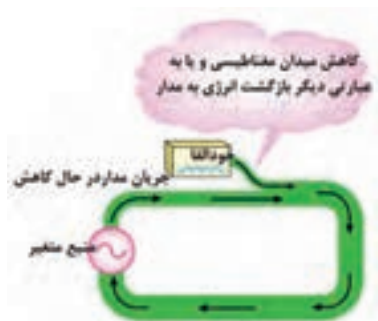
شکل ۲۷ - بازگشت انرژی به مدار
