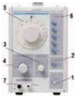
شکل ۳۸ - کلیدهای حوزه کار یا رنج فرکانس
