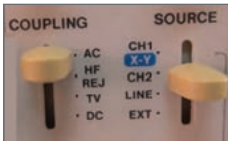
شکل ۶۹- وضعیت‌های کلید Source
