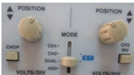
شکل ۶۳ - کلید معکوس‌کننده فاز کانال ۲
