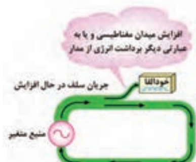
شکل ۲۶ - ذخیره انرژی در سیم پیچ
