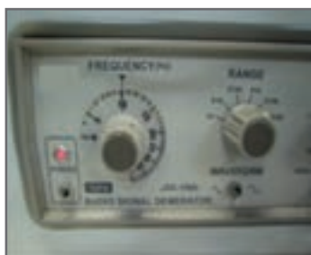
شکل ۳۹ - کلیدهای حوزه کار یا رنج فرکانس
