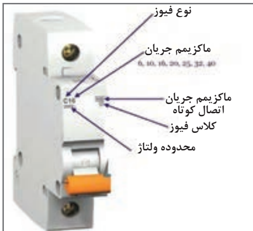
شکل ۱- مشخصات یک نوع فیوز مینیاتوری
