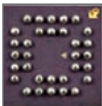
شکل ۲۱- تصویر ظاهری انواع پکیج‌های BGA
