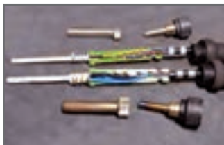
شکل ۱۳۶- اجزای داخلی کمپرسور
