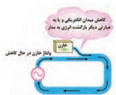
شکل ۲۹ - بازگشت انرژی به مدار
