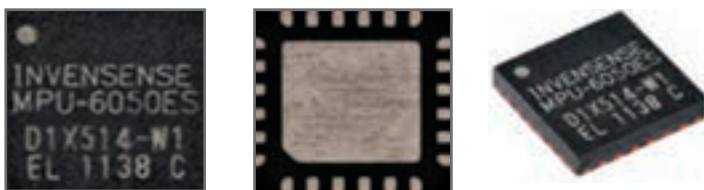
شکل ۲۰- تصویر ظاهری انواع پکیج‌های TDFN، DFN
