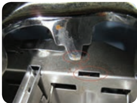
شکل ۵۸- خار نر و ماده جهت اتصال
