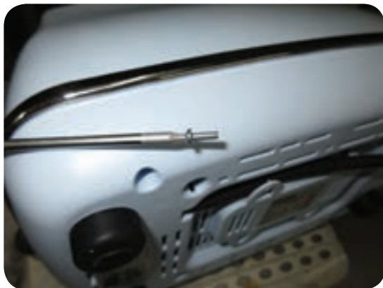
شکل ۶-۴۳ استفاده از ابزار خاص برای پیچ‌های ویژه
