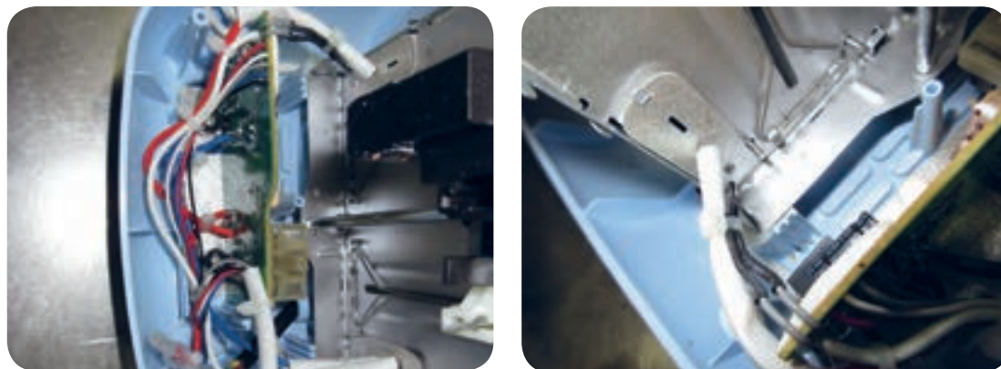
الف شکل ۶-۴۹ محل قرار گرفتن حسگر حرارتی
