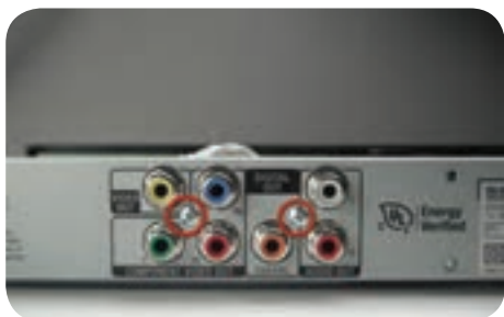
شکل ۲۲-۶ باز کردن پیچ‌نهایی برد پردازشگر
