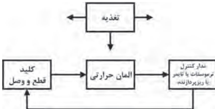
شکل ۶-۳۸ بلوک دیاگرام توستر
