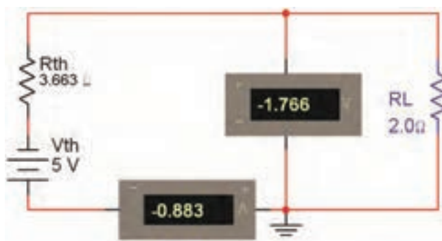
شکل ۸-۱۳- اندازه‌گیری جریان بار در مدار معادل تونن
