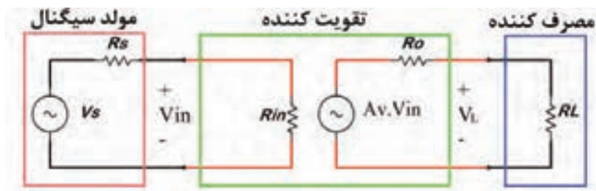
شکل ۸-۳۴ معادل تقویت کننده با مولد سیگنال و بار
