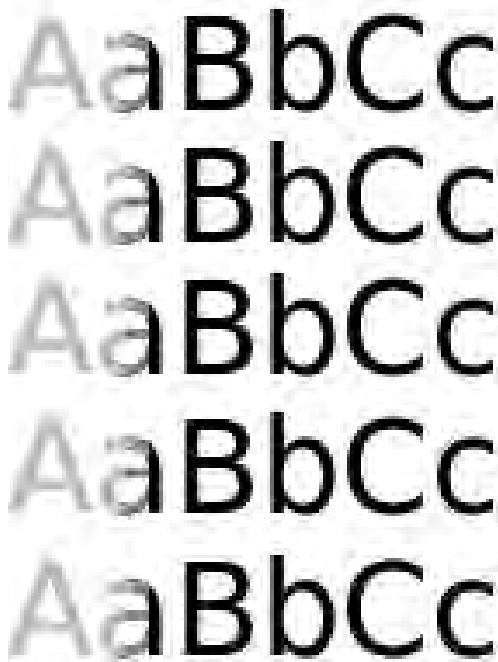
شکل ۲۸-۳- نمونه سفیدگیری چاپ
