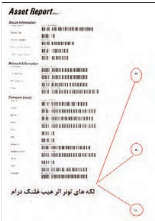
شکل ۴۵-۳- غلتک درام معیوب و اثر عیب درام بر روی چاپ
