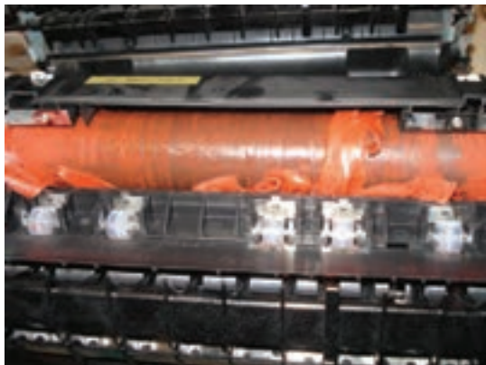
شکل ۳-۳۶- غلتک پرس معیوب
