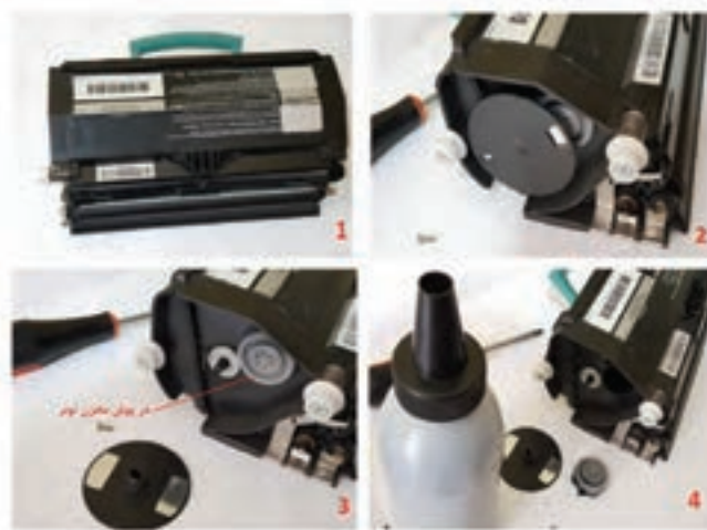
شکل ۴۸-۳- مراحل شارژ یک نمونه کارت‌تریچ لیزری
