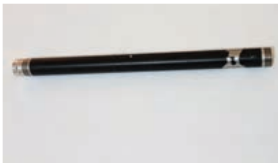
شکل ۳-۳۷- غلتک هات معیوب
