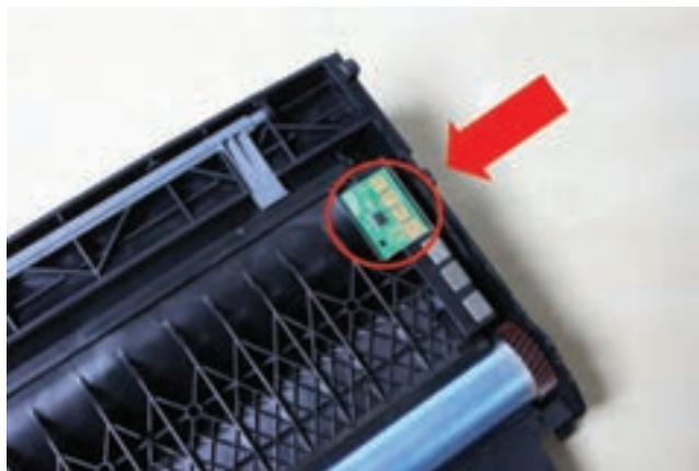
شکل ۴۶-۳- کارتریج مجهز به برد چیپ ست
