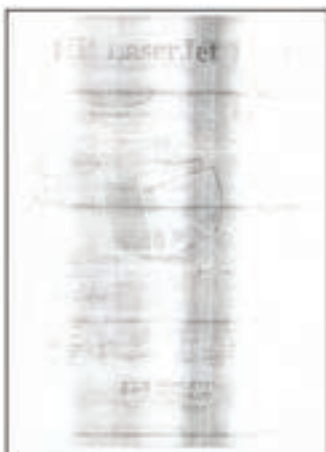
شکل ۴۴-۳ نمونه چاپ با کارتریج معیوب
