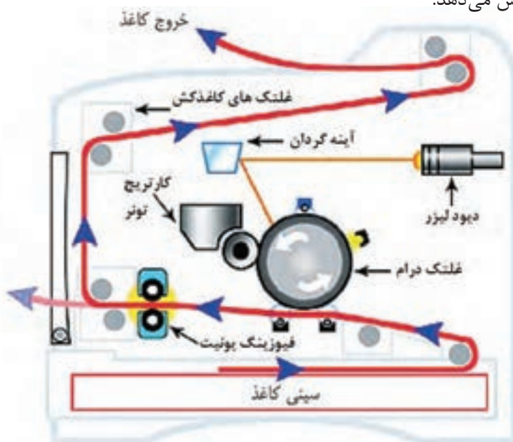
شکل ۱-۳۵- مسیر حرکت کاغذ در پرینتر لیزری
