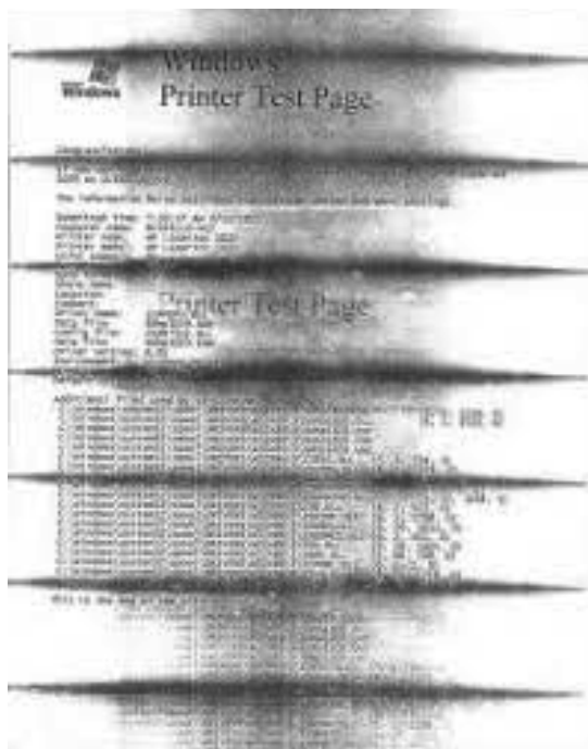
شکل ۱-۳۹- چاپ سیاه به دلیل خرابی کارتریج
