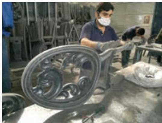
شکل ۵-۲۹ پرداخت با دست
