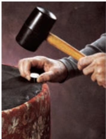
شکل ۴-۶۷- کشیدن و کوبیدن پارچه شکل ۴-۶۸- نصب پایه زیر کف
