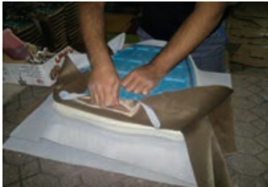
شکل ۵-۵۰- ثابت کردن پارچه از یک طرف
