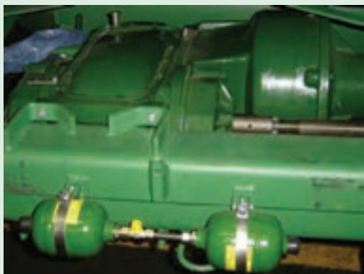
شکل ۳۷- آکومولاتور سیستم تعلیق هد کمباین جان‌دیر ۱۰۵۵
