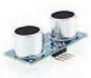
شکل ۳۳- حسگر اولتراسونیک
