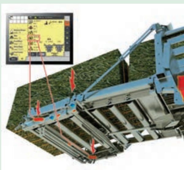
شکل ۴۹- کاربرد لودسل در بسته‌بند مکعبی
