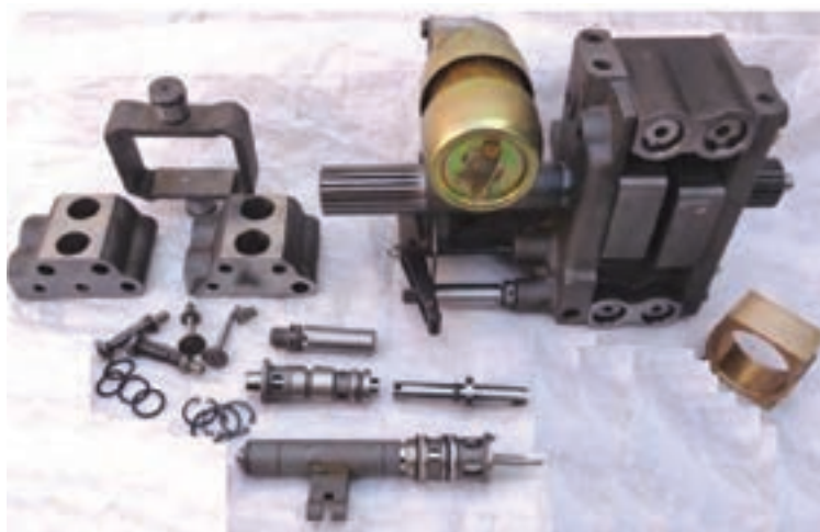
شکل ۴۸- پمپ هیدرولیک MF285
