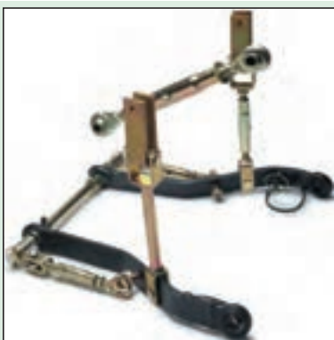
شکل ۶- میله‌ها و مفصل‌های اتصال سه نقطه تراکتور
