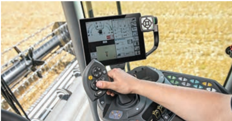
شکل ۱۵- نمونه‌ای از سامانه نظارت بر عملکرد کمباین
