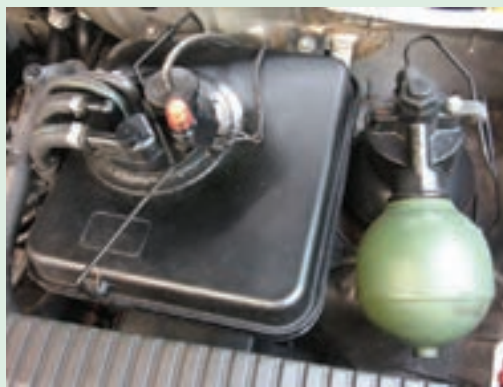
شکل ۳۶- آکومولاتور سیستم تعلیق اتومبیل زانتیا
