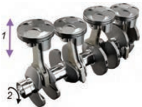
شکل ۱۹- کاربرد مکانیزم لنگ و لغزنده در موتور
