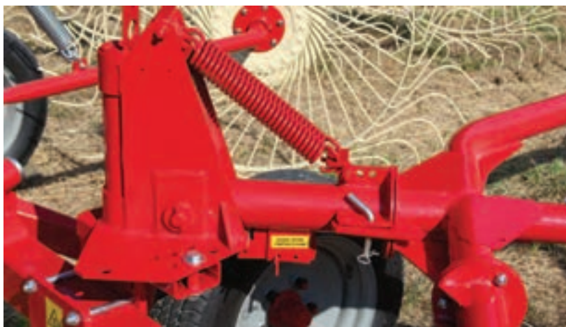
شکل ۱۵- مکانیزم شناوری شانه خورشیدی
