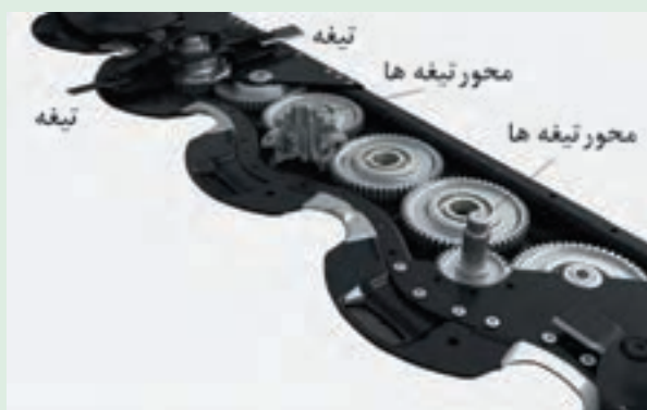
شکل ۵۱ - چرخ دنده‌های محرک تیغه‌ها در دروگر بشقابی
