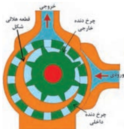
شکل ۱۵- پمپ دنده داخلی
