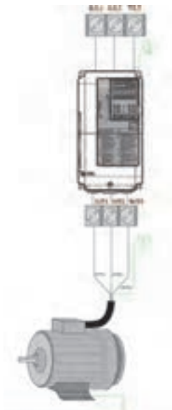
شکل ۳- ب) نحوه اتصال موتور الکتریکی به اینورتر
