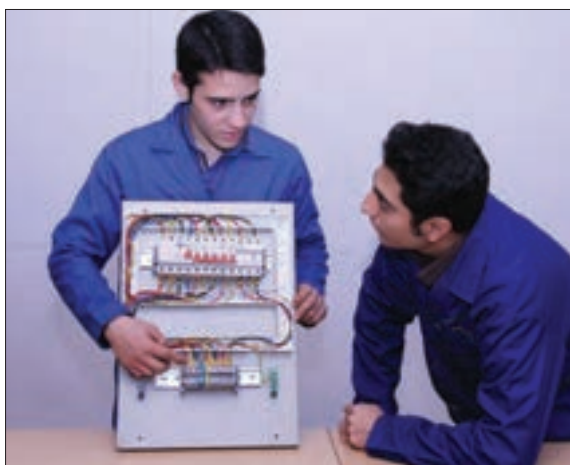
شکل ۵۴- الف) بررسی داکت‌ها و صفحه نصب
