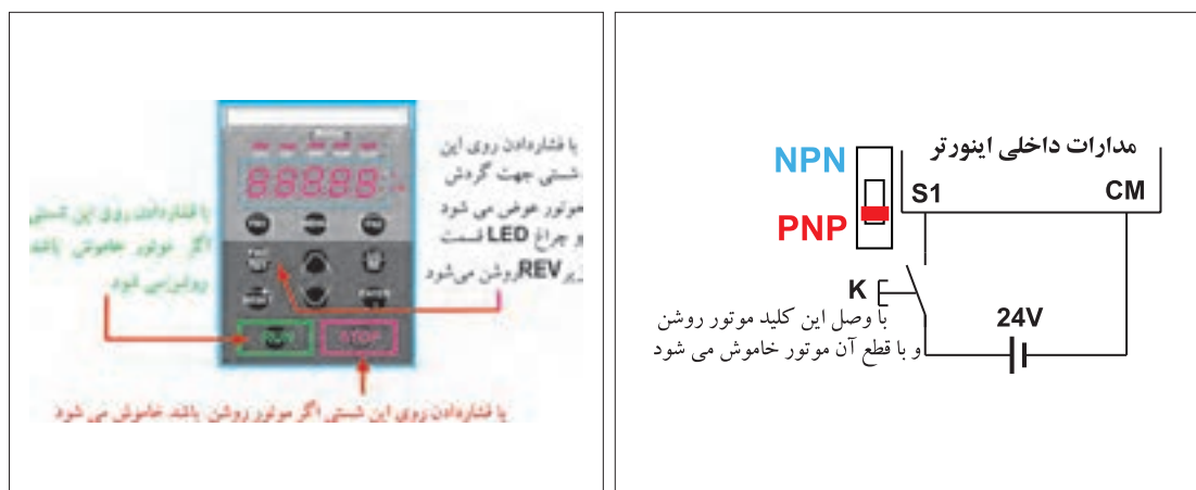
شکل ۲۱- این سه شستی روی اغلب کی پدها برای راه اندازی موتور در حالت Forward و Reverse وجود دارند.
