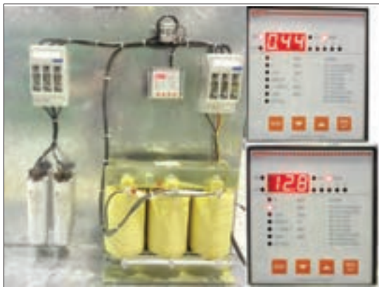
شکل ۱۷- میزان جریان و ضریب توان بار با اتصال خازن
