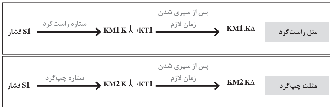
شکل ۲۶- نحوه عملکرد قطعات در مدار فرمان
