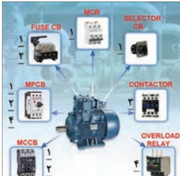
شکل ۱۰- قطعات مورد استفاده در تابلوهای راه انداز موتوری
