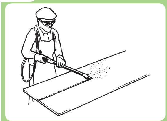
اجرای عملیات برشکاری با مشعل دستی
