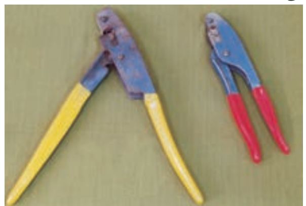
شکل ۳۵-۱- قیچی کابل بری
