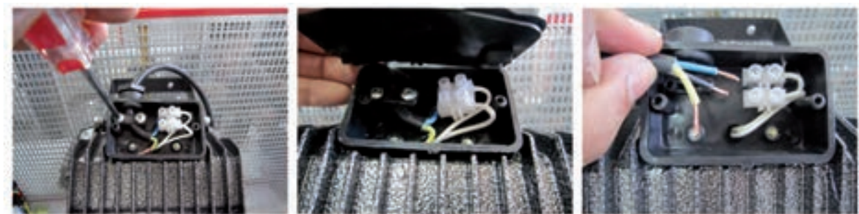
شکل ۲-۲۵ - سیم کشی در جعبه اتصالات
