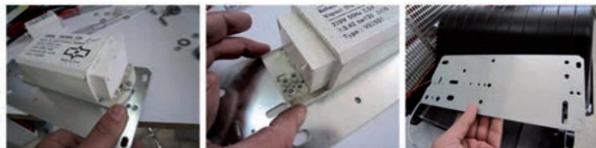
شکل ۲-۳۹ - نحوه نصب بالاست در نورافکن
