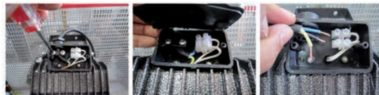
شکل ۲-۲۵ - سیم کشی در جعبه اتصالات
