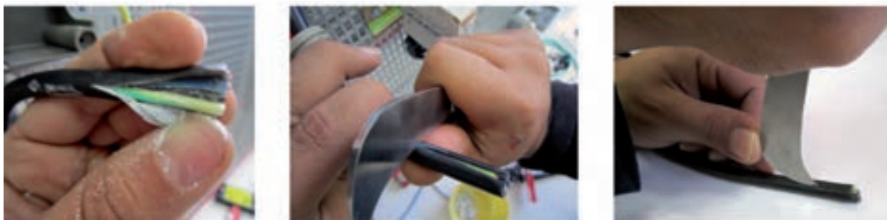
شکل ۲-۲۲ - بریدن و لخت کردن کابل
