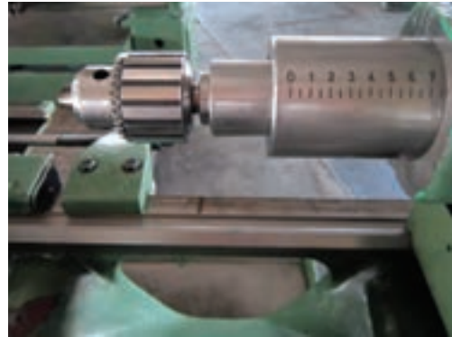
روتراشی - پله تراشی
