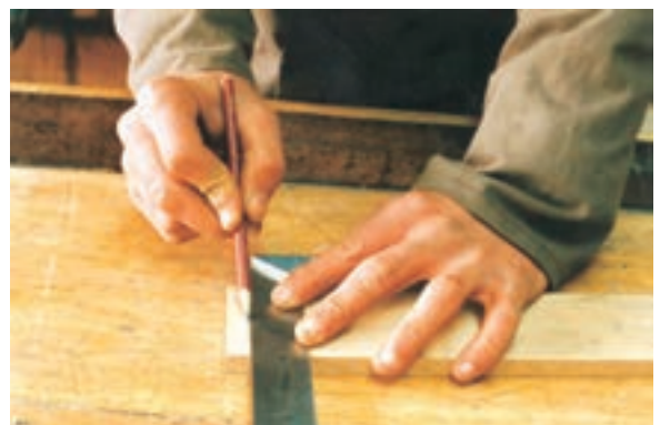
شکل ۹-۶۸- فم کشی ممل اتصال با گونیا.
