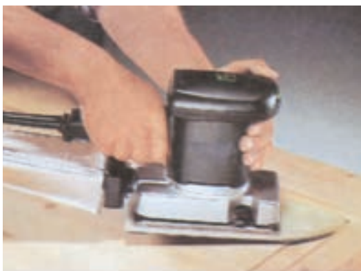
شکل ۷-۴۷- سنباده‌کاری گوشه‌های تیز داخلی با دستگاه سنباده کف مثلی.
