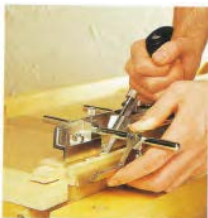
شکل ۱۰۰- شیار انداختن داخل قیده‌های عرضی.
