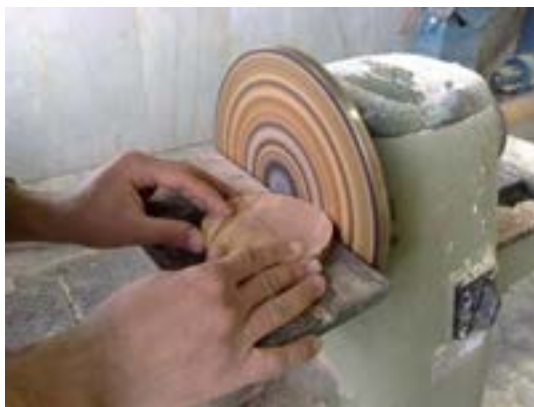
شکل ۱۹۱-۱۲. پرداخت قطعه چوب دایره شکل.
