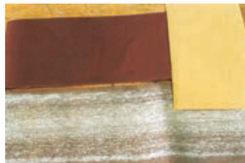
شکل ۷-۲۶. سنباده فراب و غیرقابل استفاده در مقابل سنباده‌های سالم.
