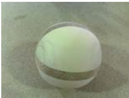
شکل ۱۲-۱۸۸- قطعه‌ی کروی خراطی شده‌ی پایه.
