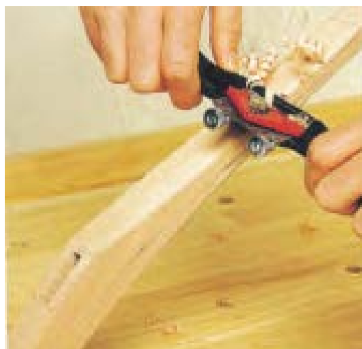
شکل ۲-۳۵. با رنده بال کبوتری، می‌توان لیسه را به طرف فود هدایت کرد.
