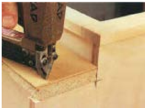
شکل ۸-۲۱- اتصال سه‌لایی به تخته خرده چوب.
