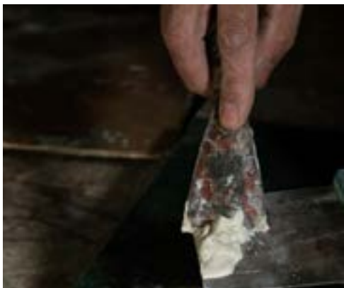
شکل ۱۸-۴. با کشیدن لیسه و کاردک به هم، باید آنها را تمیز کرد.
