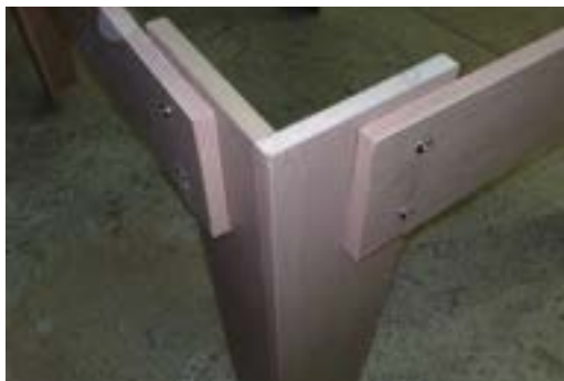
شکل ۱۲-۱۶- اتصال پایه به قید توسط پیچ فیکس.
