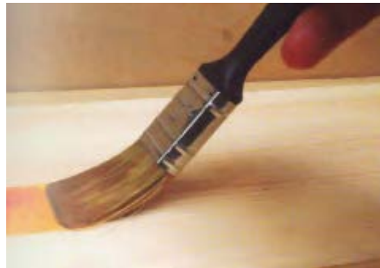
شکل ۴-۴۳- قلم‌مو را در جهت الیاف چوب بکشید.
