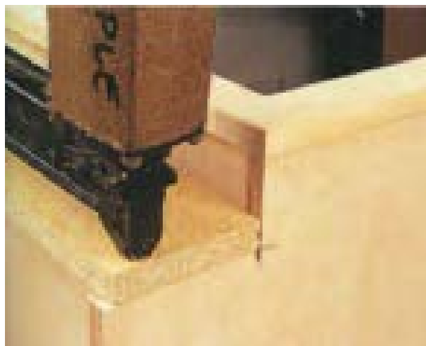
شکل ۸-۲۰- اتصال تخته خرده چوب به کابینت.
