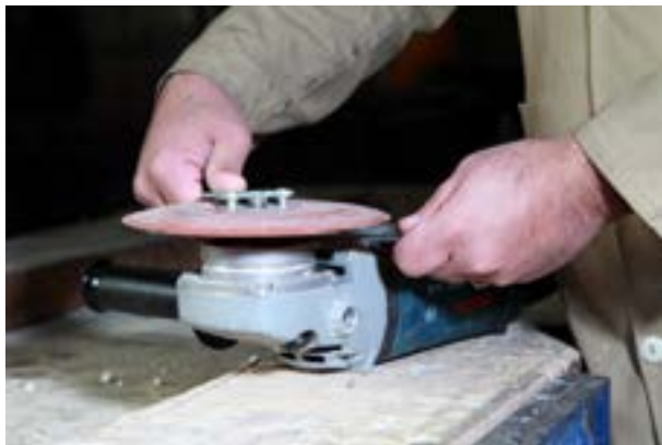
شکل ۷-۲۰- بستن ورق سنباده روی دیسک لاستیکی و ممک کردن آن با مهره‌ی مخصوص.
