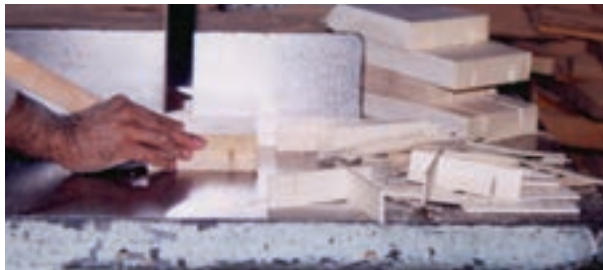
شکل ۱۱-۳۱- تولید شبکه‌های داخل در.
