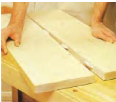
شکل ۹-۹۴- صفحه‌ی رویه، با اتصال بیسکویتی.
