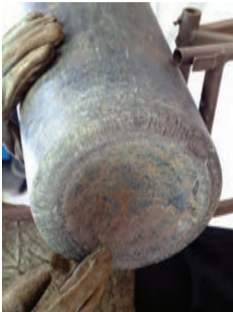
شکل ۲-۱۸- گودی ته کپسول اکسیژن
