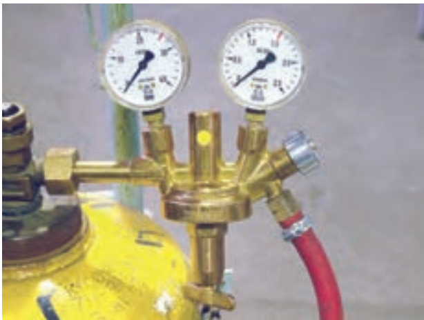
شکل ۱۳۵-۲ پیچ تنظیم فشار استیلن روی رگولاتور
