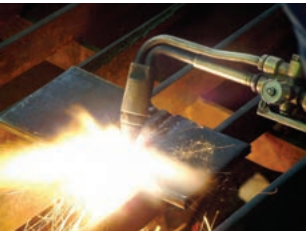
شکل ۲-۶- برشکاری با گاز
