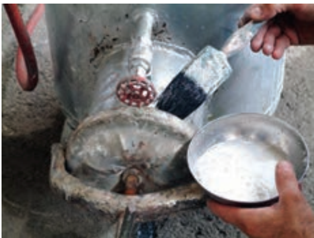
شکل ۲-۳۹- کنترل نشتی گاز
