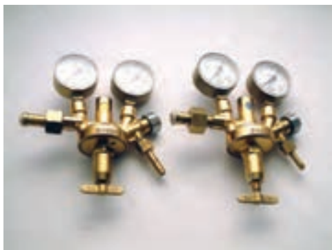
شکل ۲-۴۵- رگولاتور اکسیژن و استیلن
