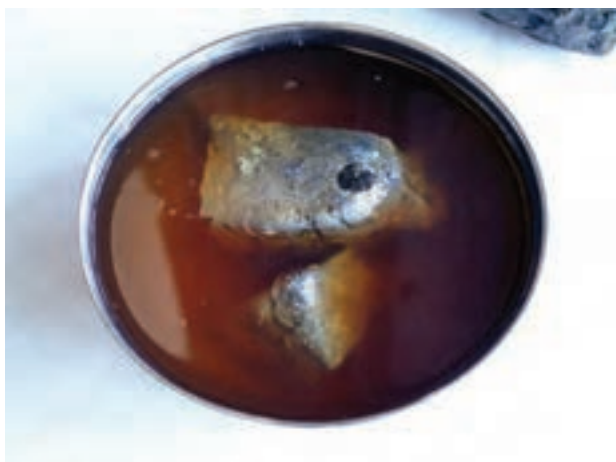
شکل ۱۲-۲ نگهداری کاربید در زیر نفت
