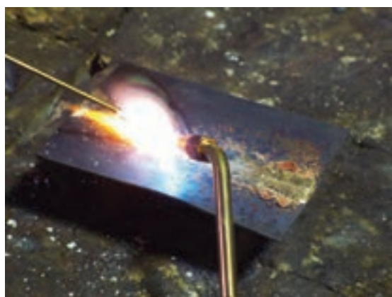
شکل ۴-۷- ایجاد گاز در اطراف محل لحیم کاری
