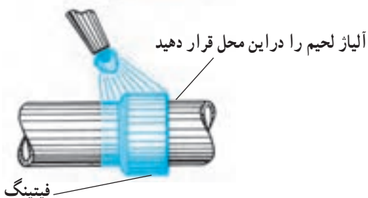
شکل ۴-۱۹- ترتیب گرم کردن لوله و فیتینگ
