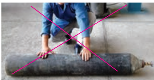
شکل ۲-۸۴ – کار اشتباه در حمل کپسول
