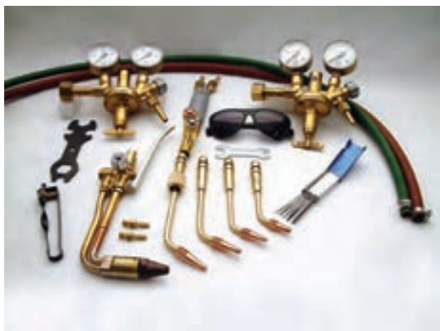
شکل ۱۵-۲ - تجهیزات جوشکاری با شعله‌ی گاز
