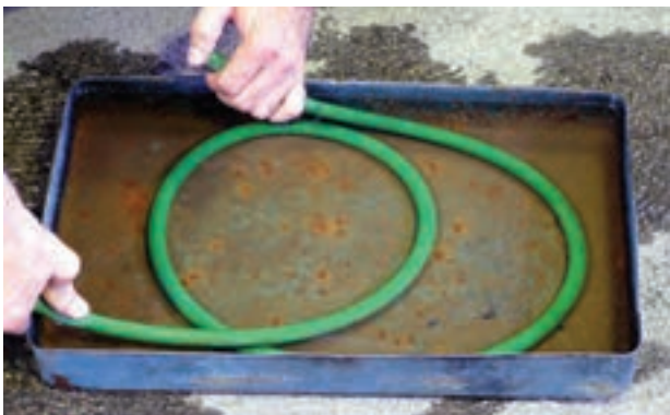
شکل ۲-۹۹- کنترل نشتی شیلنگ در آب
