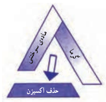
شکل ۱۶-۱- ممانعت از رسیدن اکسیژن به ماده‌ی سوختنی
