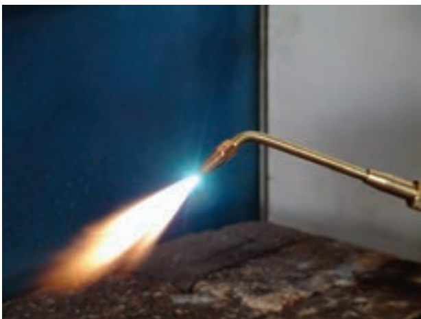
شکل ۲-۳- شعله‌ی سوختن گاز استیلن با اکسیژن
