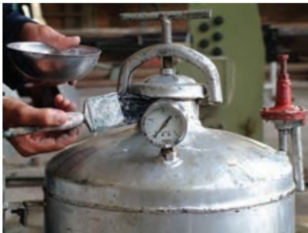
شکل ۲-۳۸- کنترل نشتی گاز
