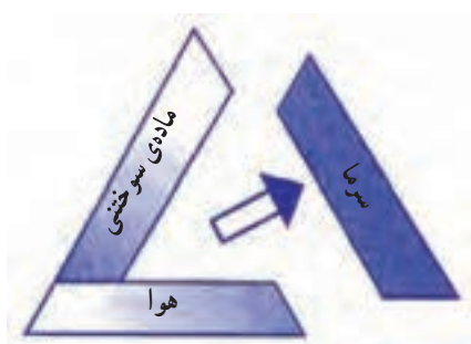
شکل ۱۵-۱- سرد کردن ماده‌ی سوختنی
