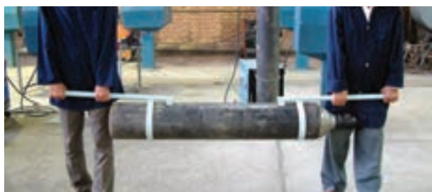
شکل ۸۶-۲ روش درست جابه‌جا کردن کپسول
