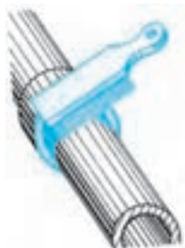
شکل ۴-۲۰- پاک کردن فلاکس اضافی پس از لحیم کاری
