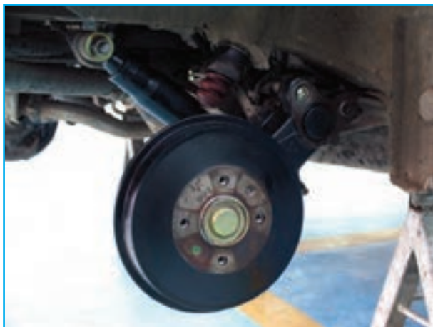
شکل ۱۸۳-۳- نصب ژامبون و متعلقات چرخ عقب
