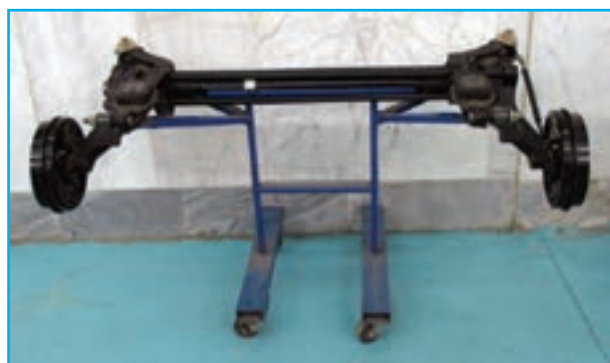
شکل ۱۵۹-۳- مجموعه تعلیق عقب
