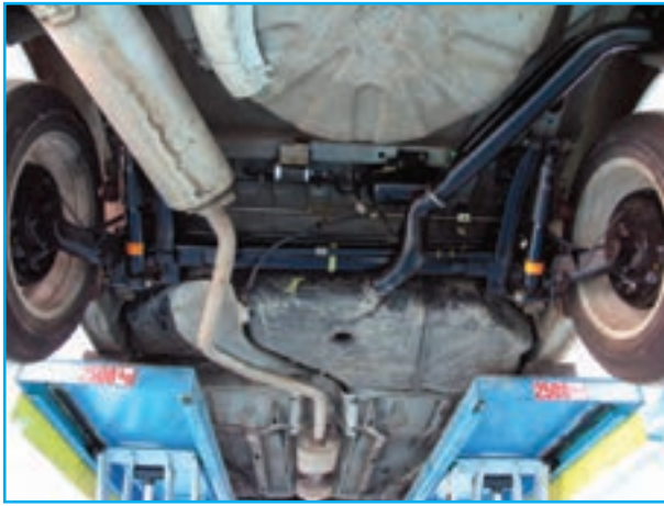
الف - باز کردن لوله‌های میانی و عقبی اگزوز
