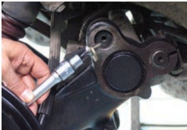
شکل ۱۷۶-۳- نصب واشر فشار و بیج‌های انتهای میله‌ها
