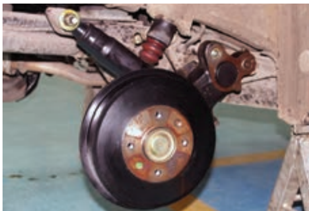
شکل ۱۷۷-۳- نصب کمک فنر
