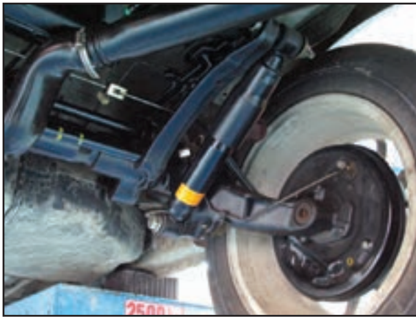
شکل ۱۶۱-۳- محل استقرار کمک فنر و پیچ‌های بالا و پایین آن
