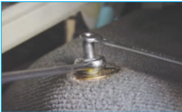
شکل ۳-۶۳- باز کردن مهره اتصال بالای کمک فنر
