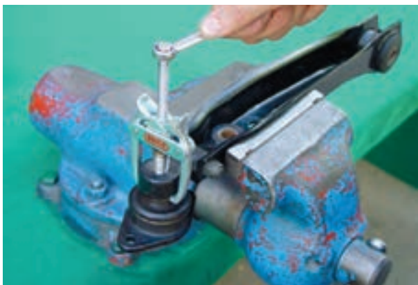
شکل ۳-۸۵- جدا کردن سیبک از بازوی اتصال
