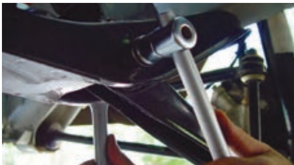
شکل ۳-۸۳- باز کردن طبق از رام
