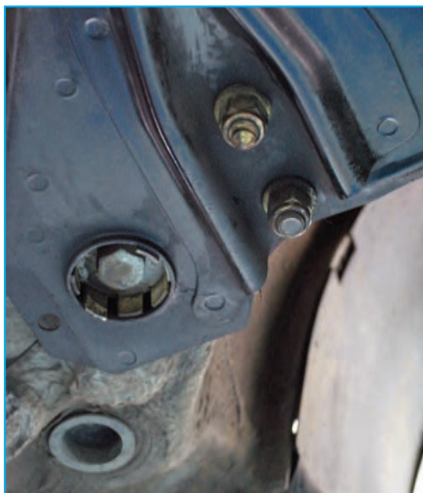
شکل ۱۳۰-۳- پیاده کردن میل موج گیر بلند
