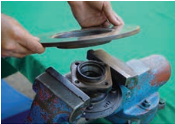
شکل ۳-۹۸- جدا کردن دیسک ترمز از تویی چرخ
