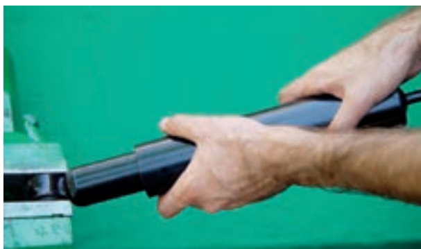
شکل ۳-۷۴- آزمایش کمک فنر
