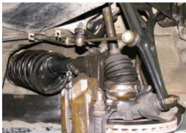
شکل ۱۳۱-۳- نصب میل موج گیر کوتاه
