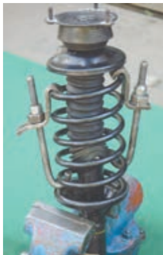
شکل ۳-۸۹- جمع کردن فنر با استفاده از فنر جمع‌کن دست‌ساز
