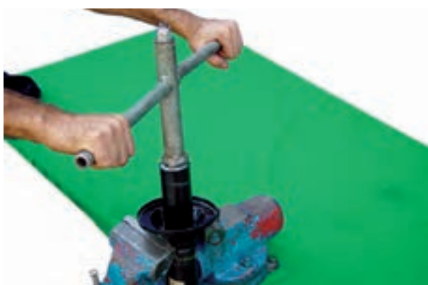
شکل ۳-۹۱- باز کردن مهره نگه‌دارنده کمک فنر
