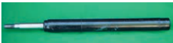
شکل ۳-۹۲- کمک فنر قابل تعویض
