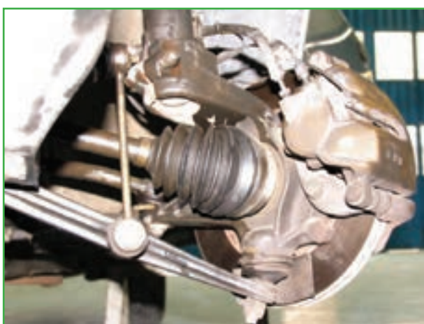
شکل ۳-۱۲۸- باز کردن پیچ‌های میل موج‌گیر
