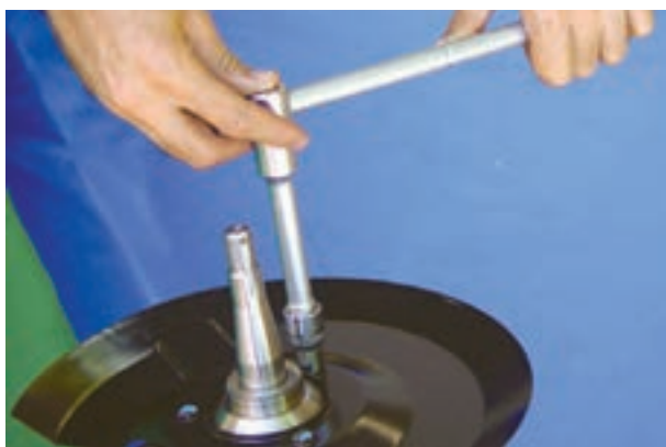
شکل ۳-۹۶- باز کردن صفحه پشت توپی چرخ
