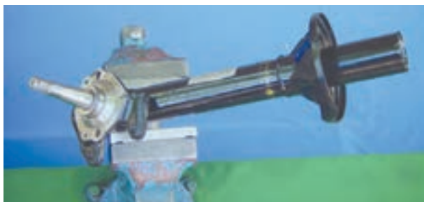
شکل ۳-۹۷- پوسته کمک فنر و محور چرخ
