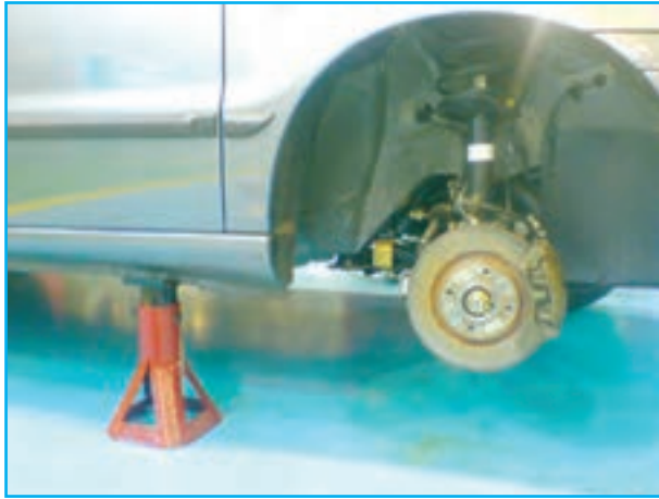
شکل ۳-۶۱- خودروی مستقر بر پایه قابل تنظیم
