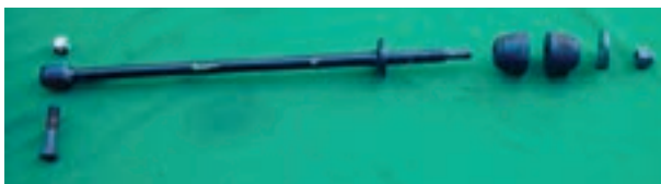
شکل ۳-۸۴- اجزای میل تعادل
