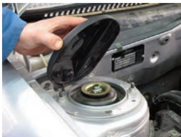
شکل ۳-۱۰۳- برداشتن پوشش بالای تکیه‌گاه کمک فنر
