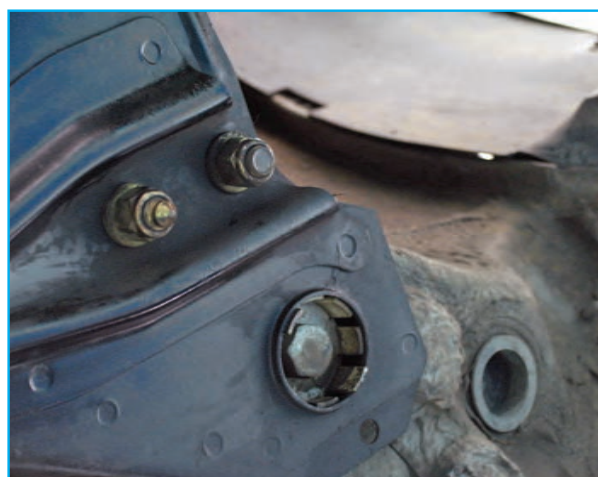
شکل ۳-۱۲۲- باز کردن پیچ‌های طبق
