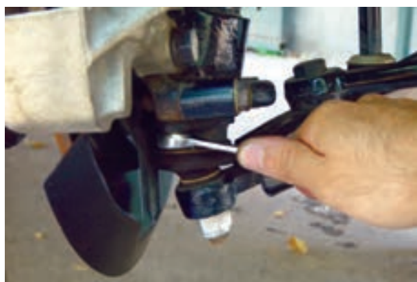
شکل ۳-۷۸- باز کردن سیبک زیر کمک فنر
