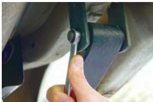
شکل ۳-۶۵ – باز کردن مهره‌های گوشواره فنر شمش
