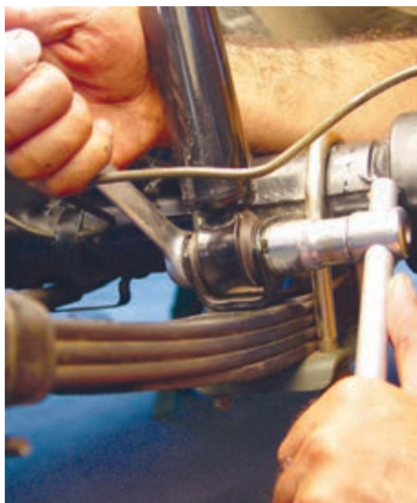
شکل ۳-۶۴ – باز کردن پیچ و مهره اتصال پایینی کمک فنر
