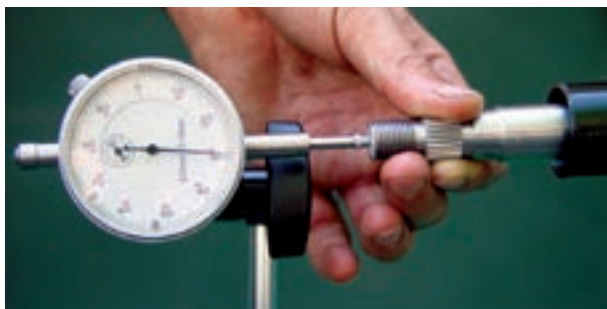
شکل ۶۸-۲- اندازه‌گیری لقی طولی میل فرمان
