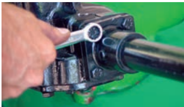
شکل ۲-۶۰- باز کردن پیچ‌های لوله فرمان
