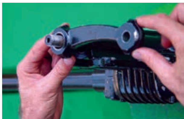
شکل ۲-۵۹- پیاده کردن اهرم هزار خار
