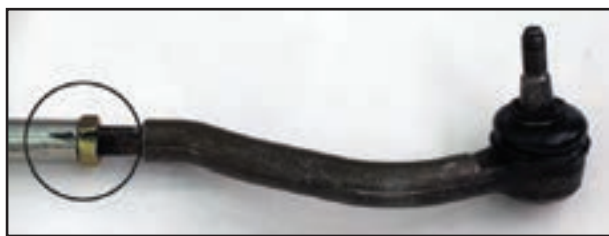
شکل ۲-۷۴- علامت گذاری سبیک و میل رابط
