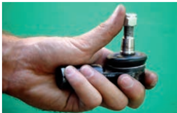
شکل ۸۴-۲- کنترل لقی سیبک‌ها
