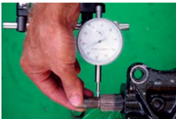
شکل ۷۱-۲- اندازه‌گیری لقی جانبی محور هزار خار
