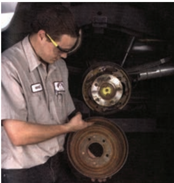
شکل ۹۶-۱- کنترل کاسه چرخ
