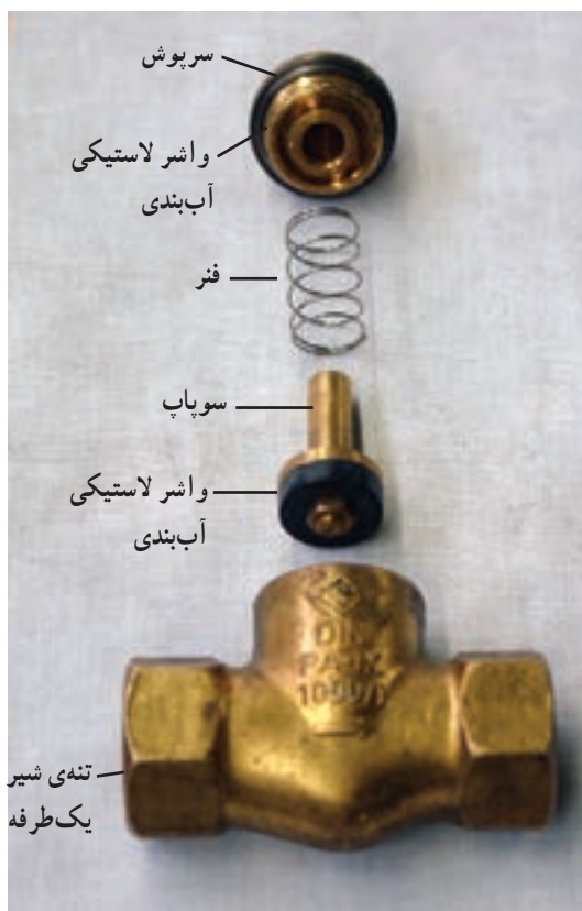
شکل ۱۰۱-۲ اجزای شیر یک طرفه سوپایی
