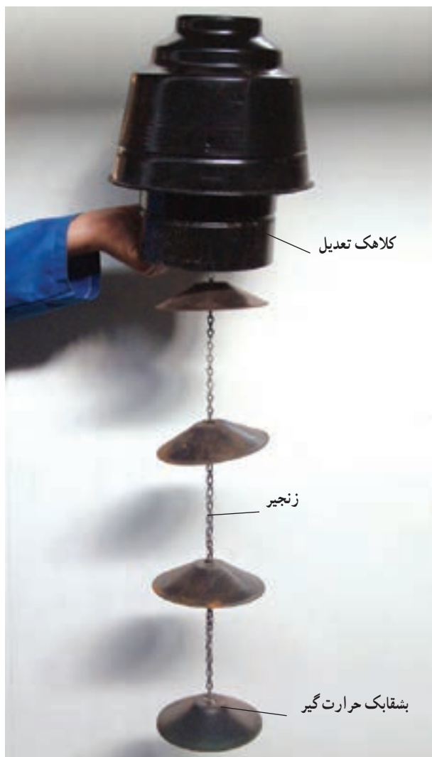
شکل ۹۴-۱- حرارت گیر آب گرمکن مخزنی گاز سوز
