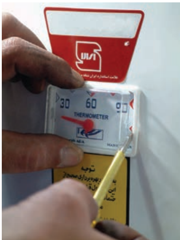
شکل ۱۱۶-۱ جدا کردن ترمومتر
