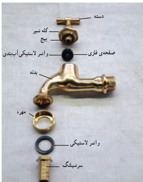
شکل ۱۲-۲- ب - اجزای شیر برنجی سرشیلنگی
