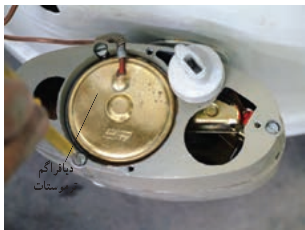
شکل ۵۵-۱- ب - دیافراگم ترموستات
