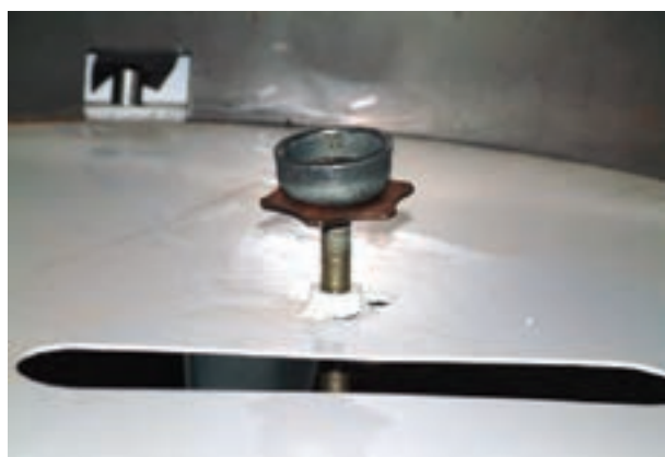
شکل ۹-۱- جک نصب شده بر روی شاسی
