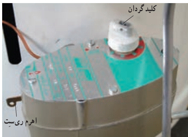
شکل ۱-۳۸- کاربراتور آب گرمکن نفت سوز
