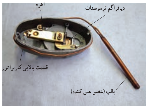
شکل ۵۵-۱- الف - ترموستات کاربراتور آب گرمکن نفت سوز
