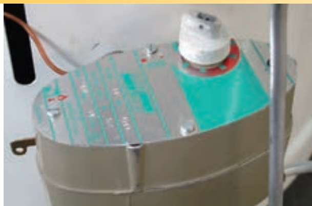
شکل ۵۲-۱- قرار دادن کلید گردان در حالت خاموش
