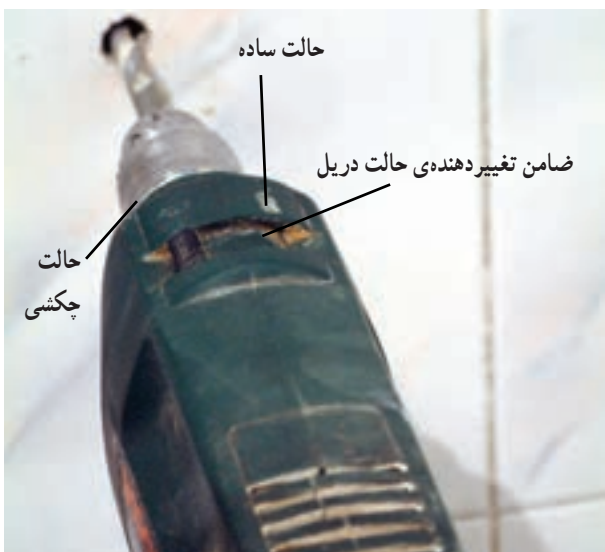
شکل ۲۱۲-۳ سوراخ کردن محل علامت‌گذاری شده
