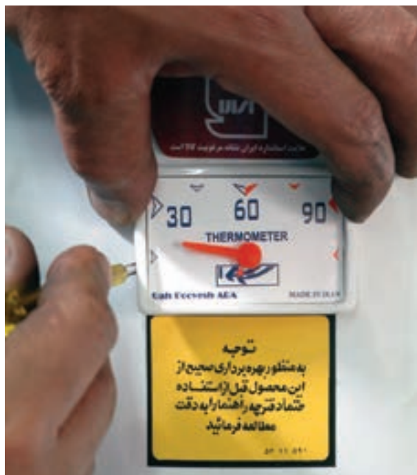
شکل ۱-۱۱۷ جدا کردن ترمومتر از روپوش
