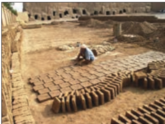
شکل ۱-۵۴ خشت خام (ساخت آجر به روش دستی)
