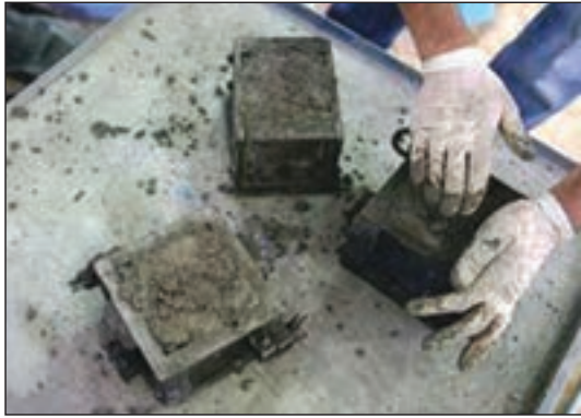
شکل ۱-۵۱ آزمایش مقاومت بتن
