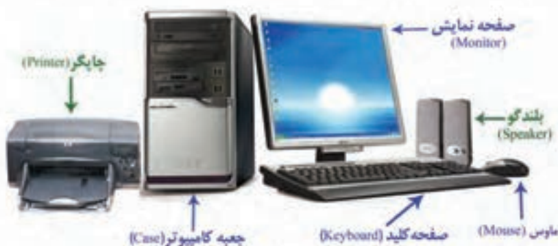
شکل (۱-۱۲) اجزای کلی یک رایانه رومیزی
