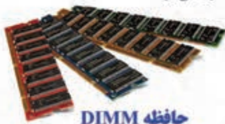
شکل (۵-۴) حافظه DIMM - فن‌آوری SDRAM
