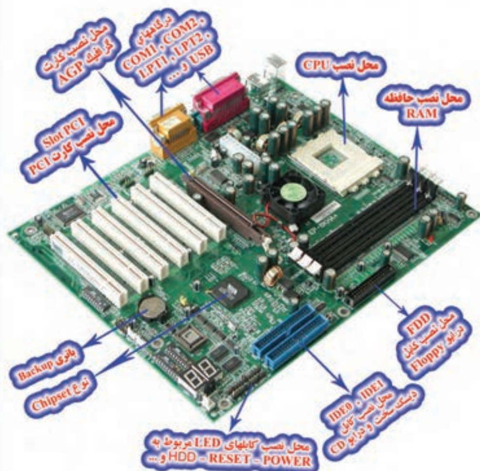
شکل (۵-۱) برد اصلی (Mainboard)
