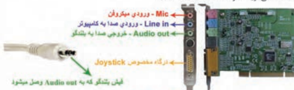
شکل (۴-۵) کارت صدا و اجزای آن
