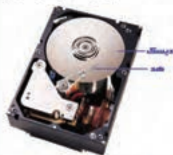
شکل (۴-۷) نمای داخلی دیسک سخت
