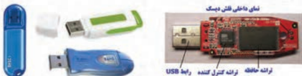
شکل (۹-۱۶) نمونه های از Flash Disk و نمای داخلی آن
