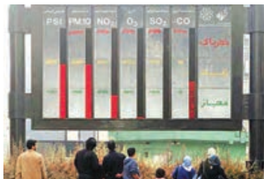
شکل ۵- الف) تابلوی شاخص آلودگی هوا
